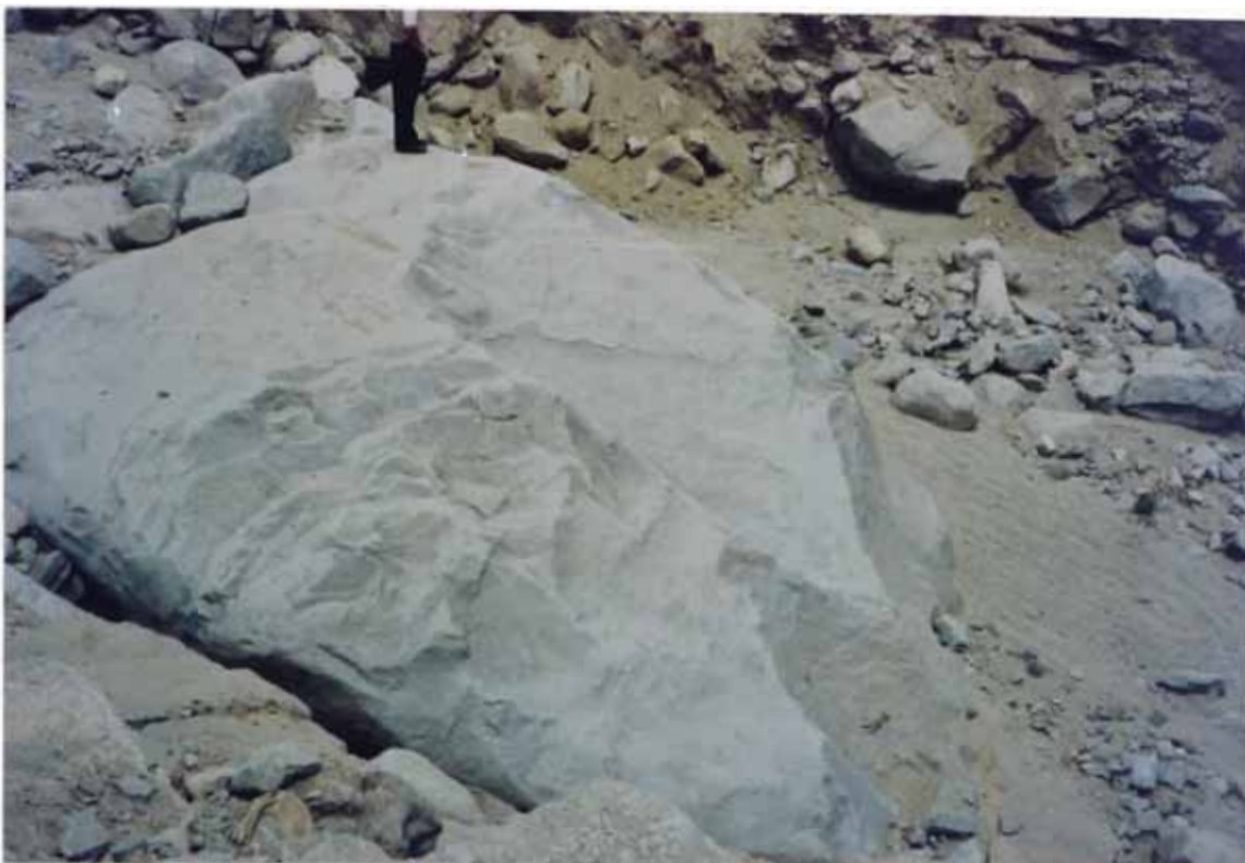
Foto 3: Quebrada Pedregal: Roca de grandes dimensiones, en pleno cauce. Longitud 10 m.; Peso aprox. 400 Ton.
