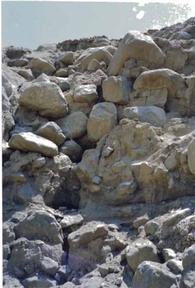
Foto 5: Quebrada Pedregal. Terraza muy inestable. Las rocas sueltas permiten rápida percolación del agua. En la parte inferior puede observarse un lente arenoso que separa 2 eventos anteriores.
