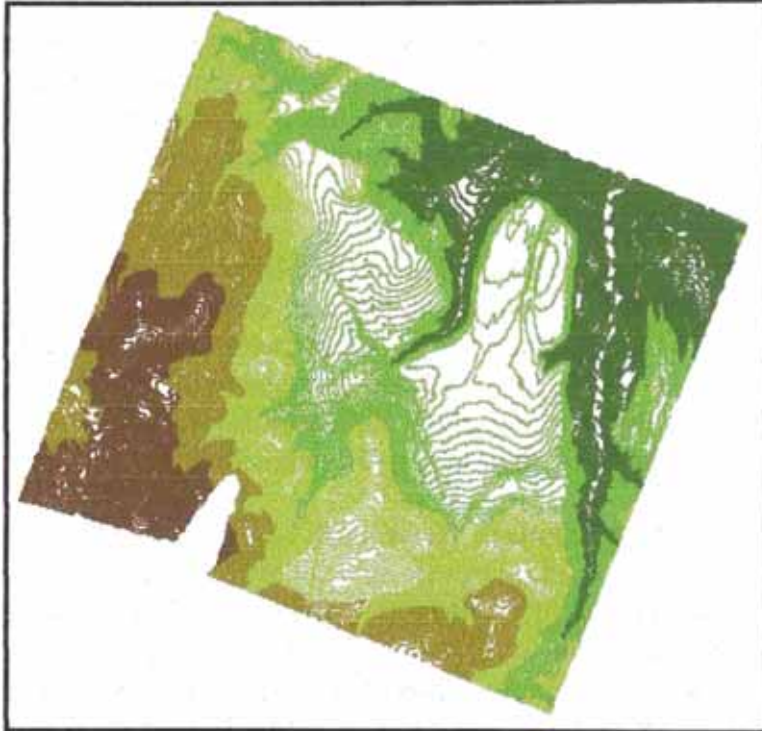
Figura 4.11. Generación de un modelo TIN a partir de una cobertura de puntos.
