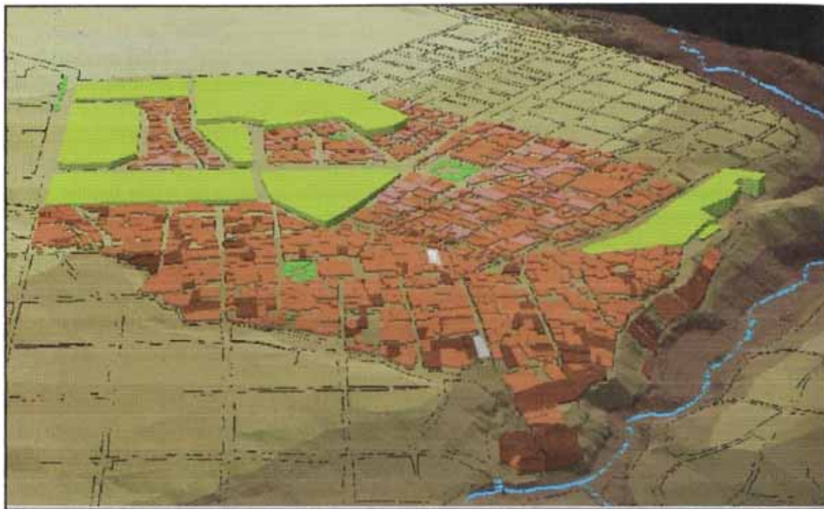
Figura 6.38: Vista tridimensional del mapa de escenarios de daño para una aceleración de 0.1g en el basamento rocoso.
