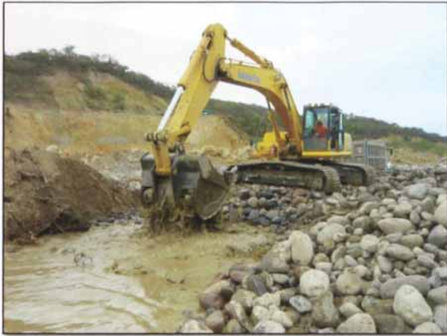
Foto N°6: Segundo Paso, extracción y lavado permitiendo el paso de finos y piedras menores.
