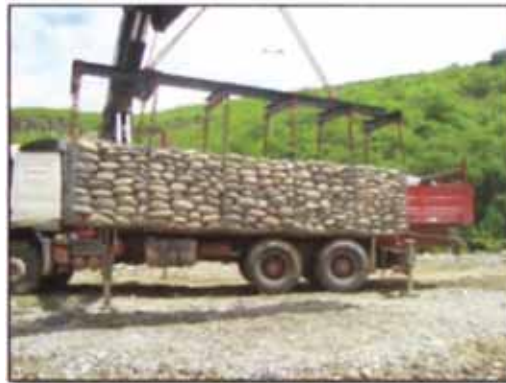
Fotos 12 y 13: Prueba de Carga con estructura de izaje metálica y cadenas
