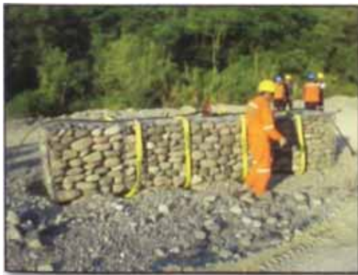
Fotos 14 y 15: Prueba de Carga con estructura de izaje metálica y eslingas.
