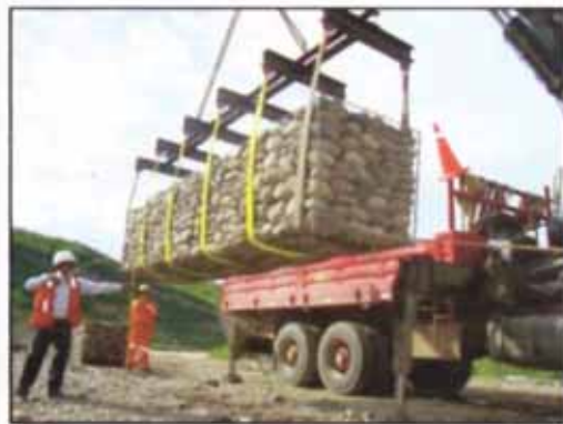
Fotos 14 y 15: Prueba de Carga con estructura de izaje metálica y eslingas.
