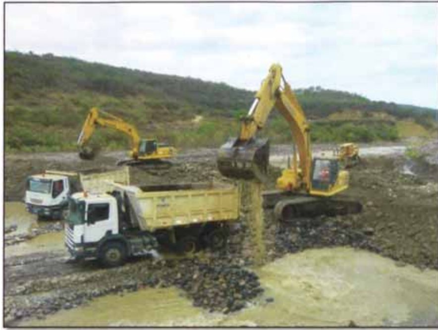
Foto N°8: Extracción, lavado y carguío en simultáneo de más de un equipo en bancos de material de buena potencia.
