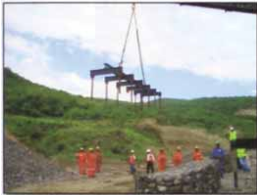
Fotos 12 y 13: Prueba de Carga con estructura de izaje metálica y cadenas
