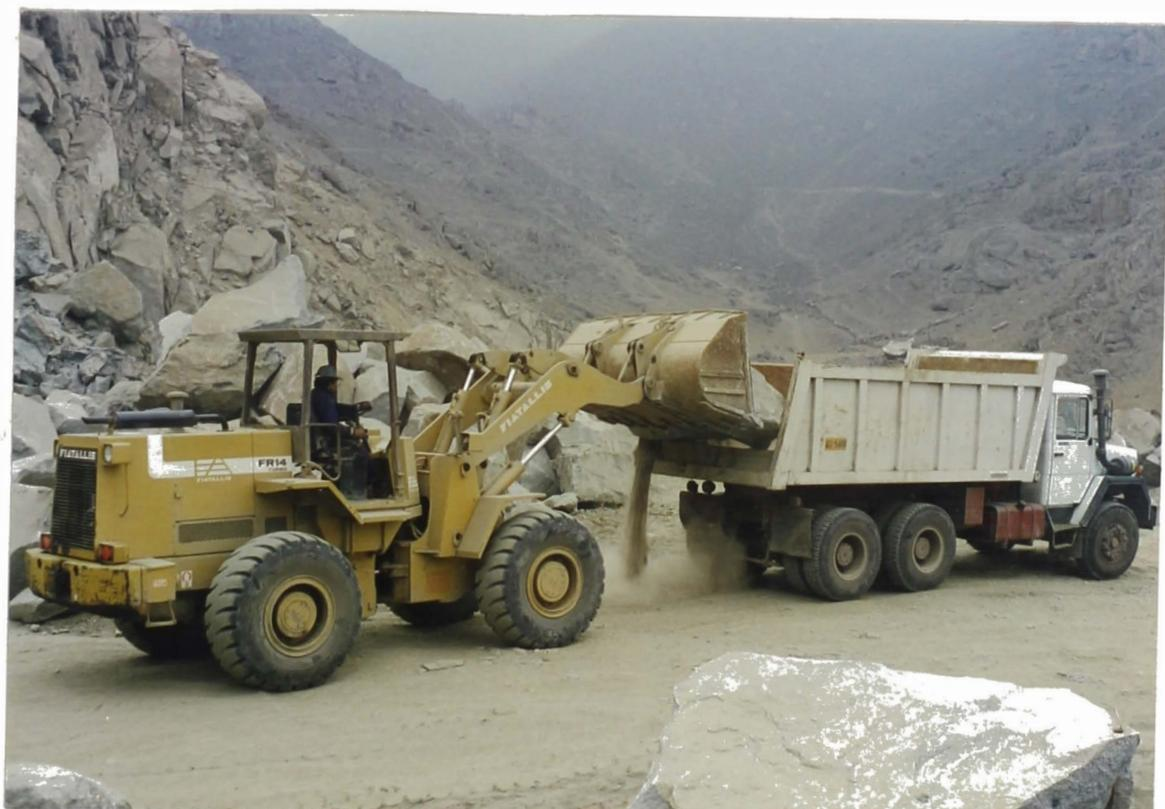
**FOTO N° 58:** *Carguío para el transporte a obra con volquetes de 12 m<sup>3</sup> de capacidad.*
