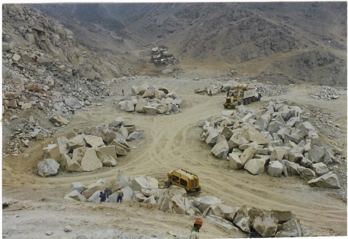
**FOTO N° 53:** *En cancha el material seleccionado listo para transporte a obra. Son agrupados seg3n peso, forma y volumen.*
