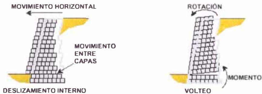
FIGURA 5.6 MODOS DE FALLA DE LA ESTABILIDAD INTERNA
