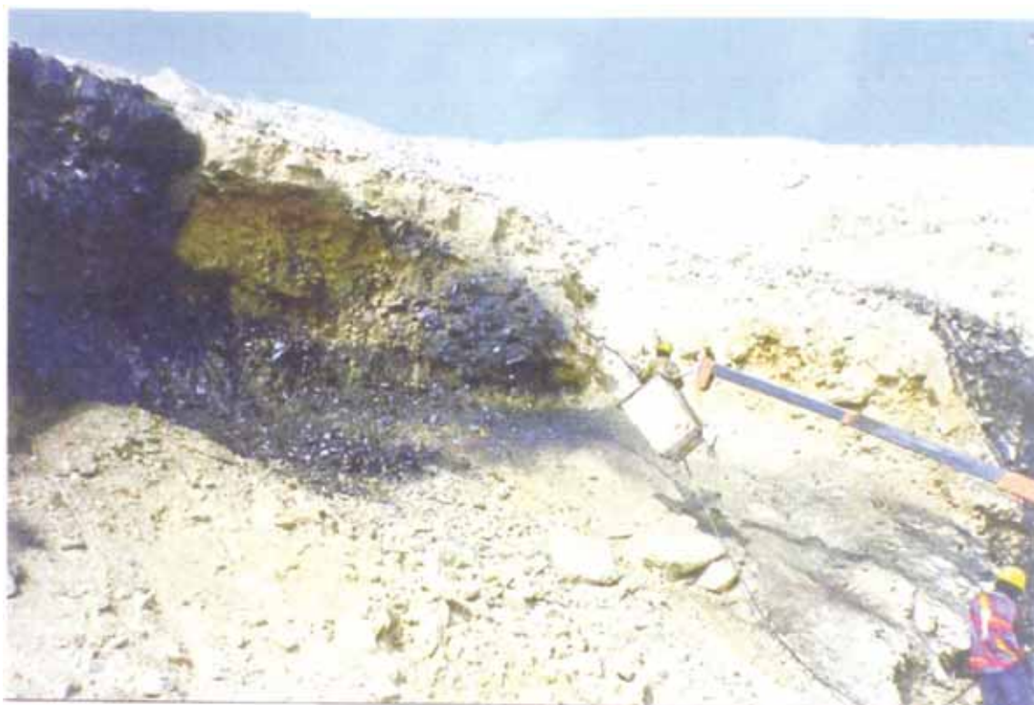
Vista 6.02.- Impregnación asfáltica en el km. 716+435 al 716+570 en suelo con agregado grueso
