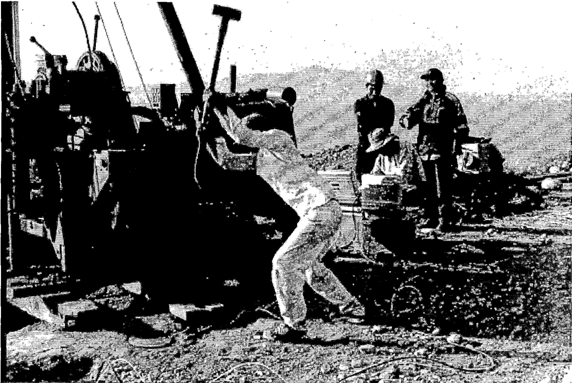
Foto 17. Generación de ondas P (Presa Tinajones) cuando el geófono esta a poca profundidad de la superficie.
