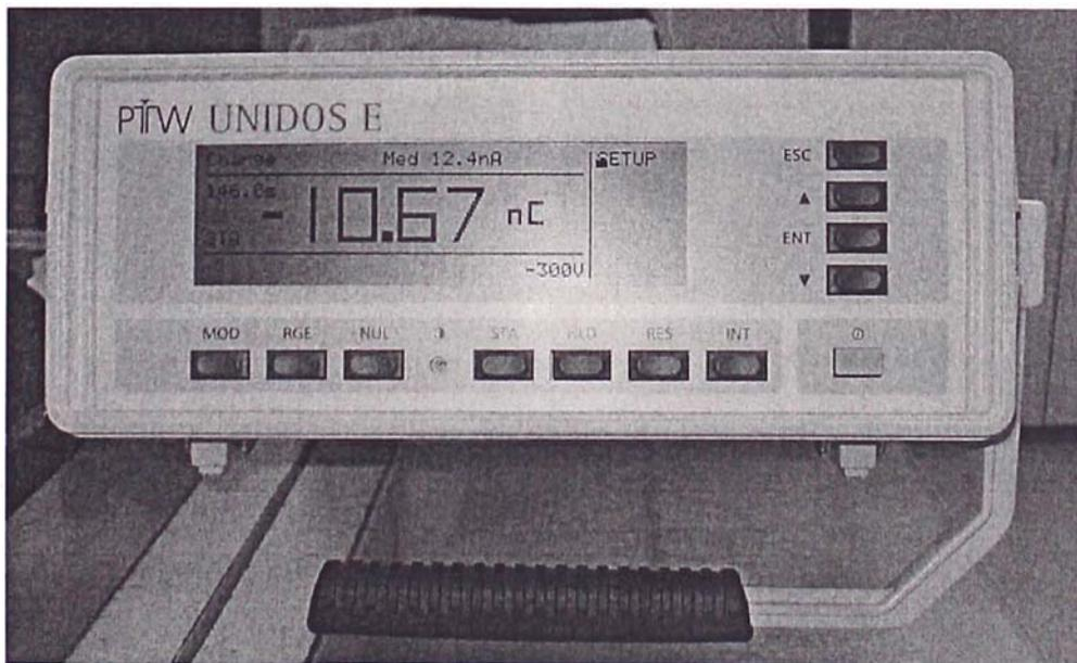
Figura 3.2. Electrómetro PTW UNIDOS E.
