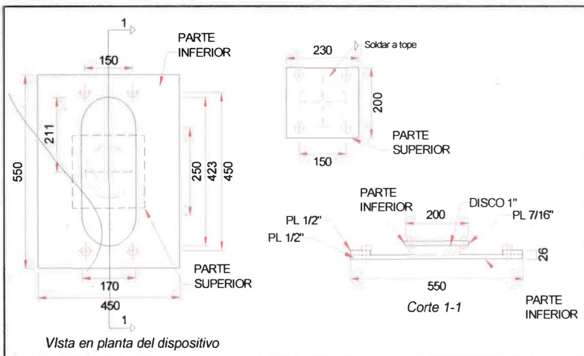
Figura 2.1 Dispositivo de aislamiento propuesto y sus dimensiones en milímetros.
