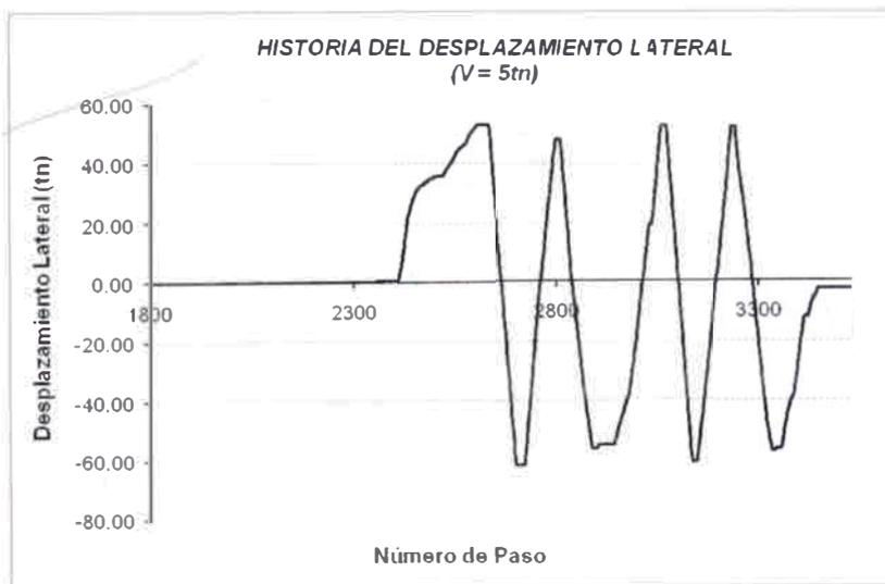
Figura 3.7 Historia del desplazamiento del dispositivo (V=5tn).
