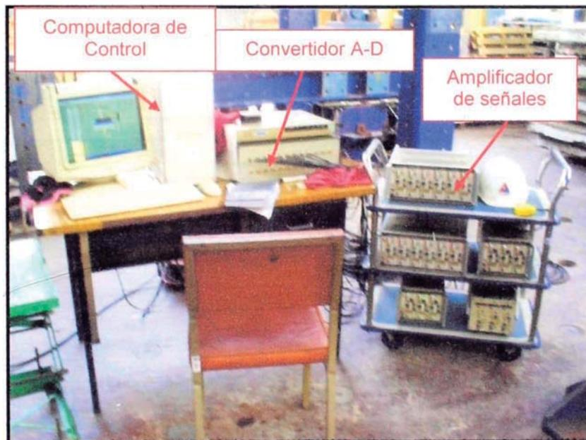
Foto 3.3 Equipo de adquisición de los datos del ensayo.
