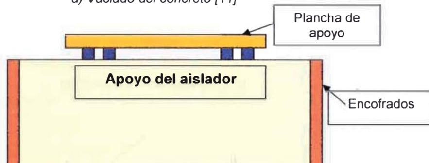
b) Esquema de vaciado.
