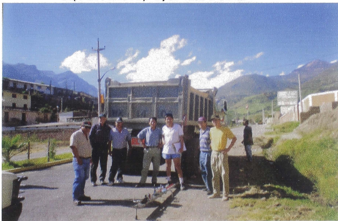
FOTO N° 16 Ensayo de las deflexiones con la Viga Benkelman al ingreso de la Ciudad de Canta.
