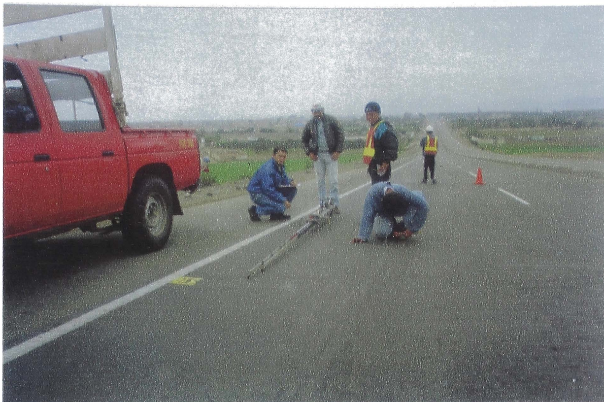
FOTO N° 15 Vista Panorámica del ensayo con la Viga Benkelman y la Toma de la Temperatura de la Carpeta y del medio ambiente.
