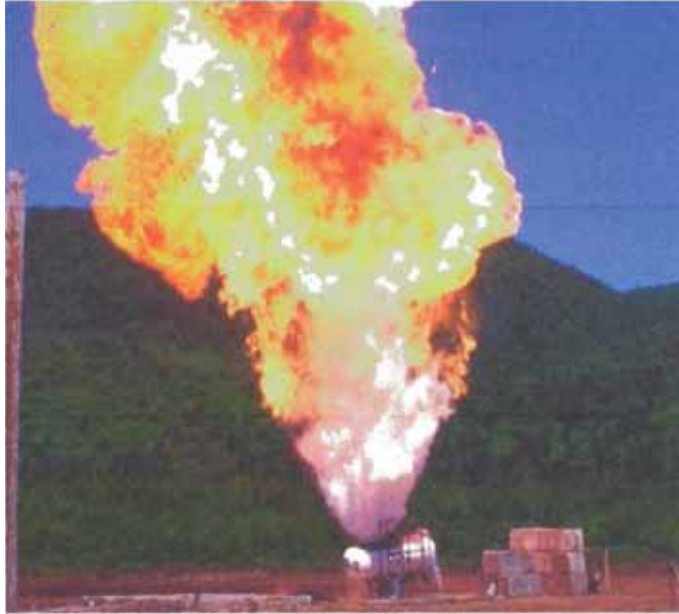
Figura 2.11 Explosión por la expansión de un líquido en ebullición - BLEVE
