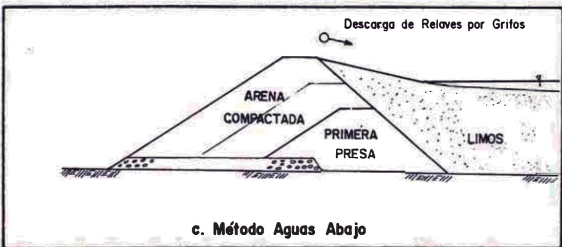
**Figura 10.- Construcción de Presas de Relaves con Descarga por Grifos (Ref. 7).**
