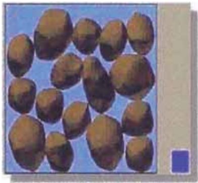
Figura N° 1.1 : Representación de partículas en un depósito de suelo. La altura de la columna en azul a la derecha representa el nivel de la presión de agua de poros en el suelo.
