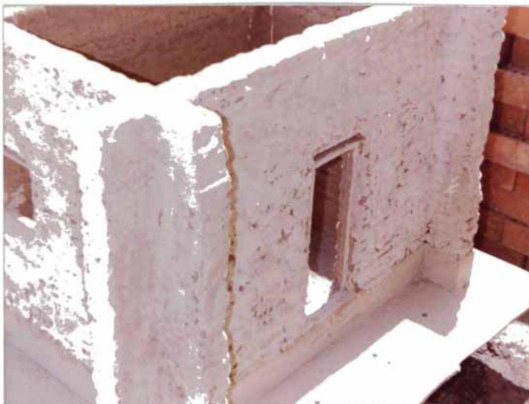
**Fig. 3.** Muro 3, perpendicular a la dirección del movimiento. Vano de puerta en el centro del paño.
