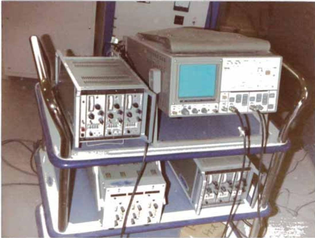
**Fig. 3.** Vista del Osciloscopio. Puede recibir señales de nueve acelerómetros a la vez.
