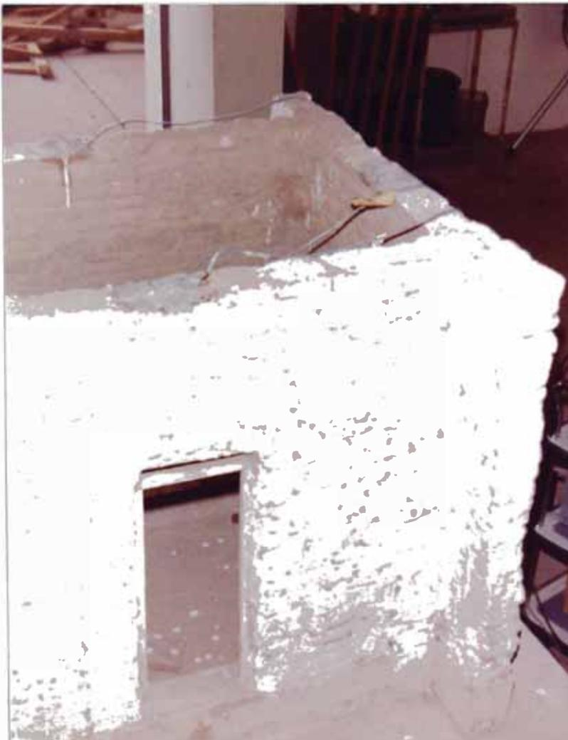
**Fig. 4.** El modelo colocado sobre la Mesa Vibradora listo a ser ensayado. Se puede apreciar los acelerómetros instalados sobre cada muro.
