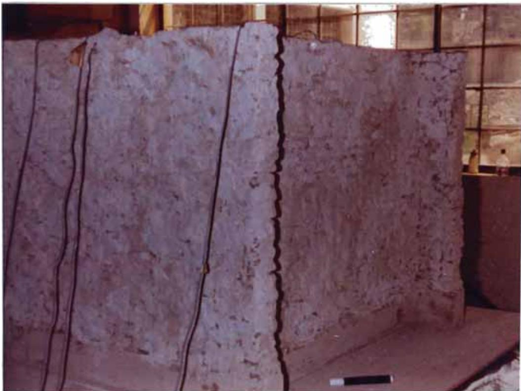
**Fig. 2.** Muros 1 y 2. No tienen ningún vano. El muro 1 es perpendicular a la dirección del movimiento.
