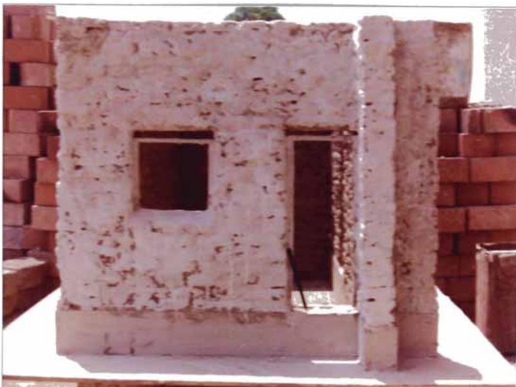
**Fig. 4.** Muro 4, paralelo al movimiento. Vanos de ventana y puerta en el paño.
