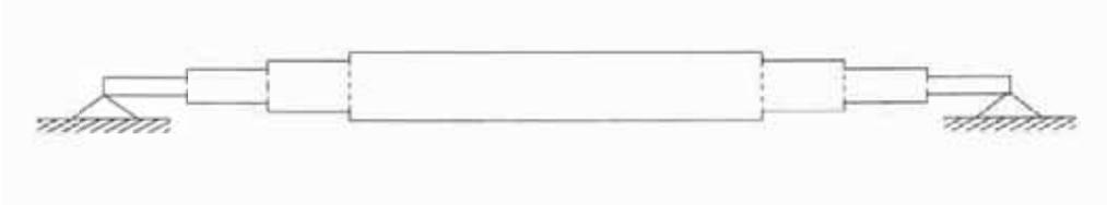
**FIGURA 2.11** Modelo de Elemento Discreto.
