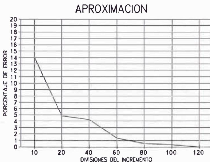
**FIGURA 3.26** Aproximación usando los incrementos de cargas laterales.
