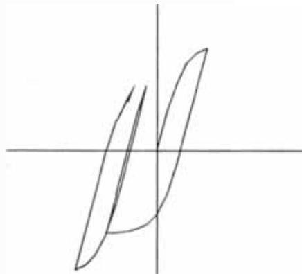
**FIGURA 4.3** Regla Histerética Multilínea sin Degradación
