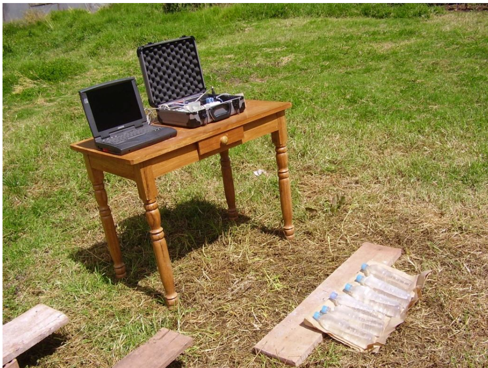
Figura 42. Fotografía del sistema en Yaurisque. Se observan a la lengua electrónica y las botellas conteniendo agua del río Yaurisque y expuestas a la radiación solar usadas para descontaminación usando el método DSAUI.
