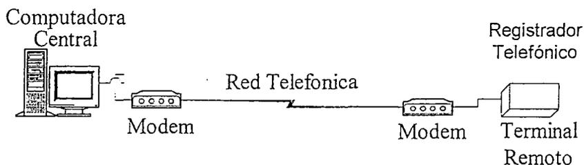
Figura 5.58. Comunicación entre la computadora central y el equipo REGISTRADOR haciendo uso de la red telefónica.
