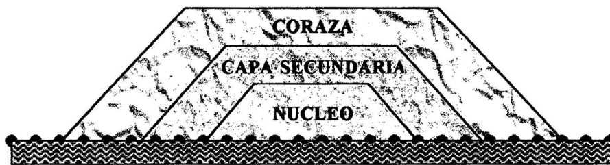
Fig. 5.6 ENROCAMIENTO A TALUD
