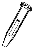
Este perno se utiliza específicamente en la unión de un esquinero exterior y los moldes aladaños. Este perno esta recortado en su cabeza para permitir un ajuste mejor en la unión de estos elementos.
