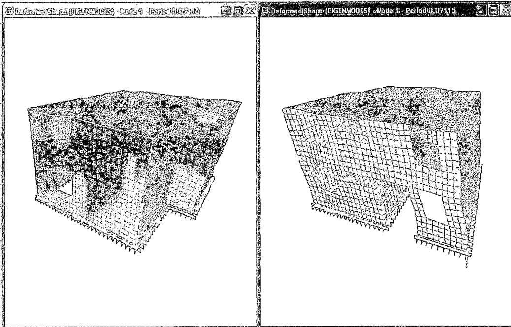
Figura 4.4 , Primer modo. Modo traslacional en la dirección X, T=0.0714 seg
