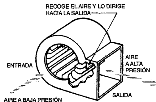
Figura 7.10 Ventilador de tipo centrífugo
