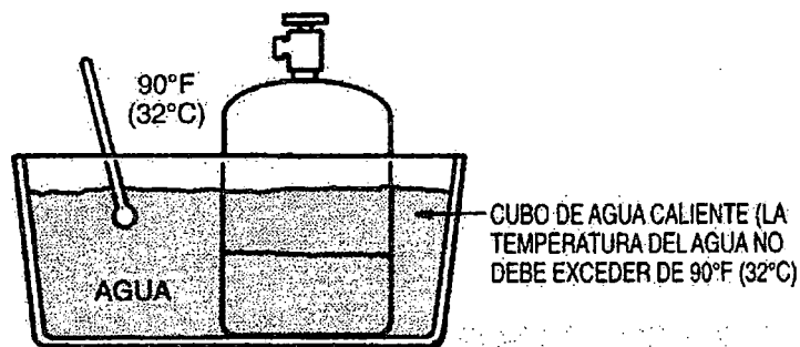
Figura 7.43 Botella de refrigerante en agua para mantener alta presión
