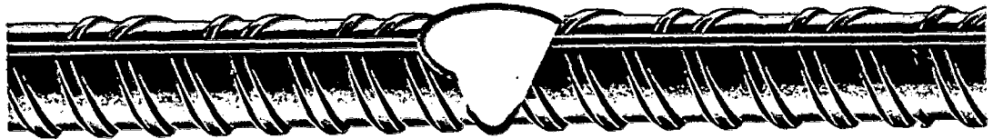
Fig. 4.10. Exceso de material en la junta.
