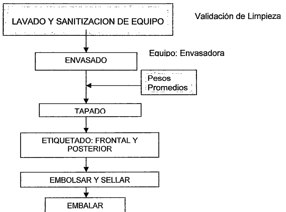
Fig. 37: Diagrama de Bloques de Envasado
