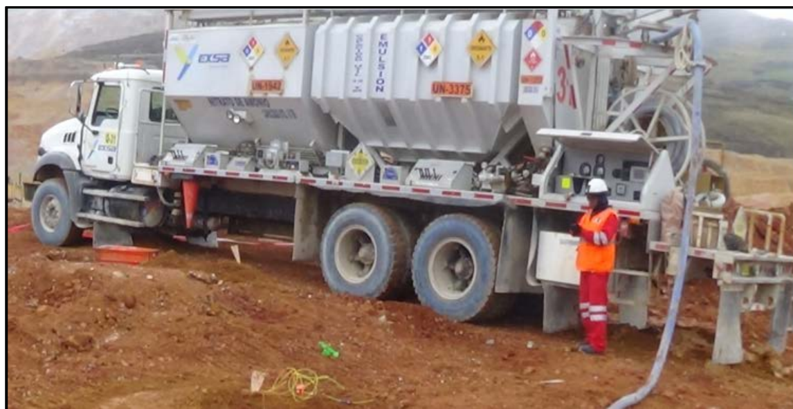
Figura 28. Sistema bombeable de carguío de explosivos usado solo para taladros con agua.
