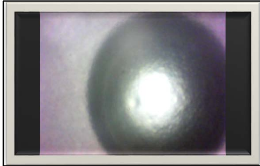
Figura 14. Burbujas de nitrógeno en la emulsión G EXSA (2014). Archivo de investigación.
