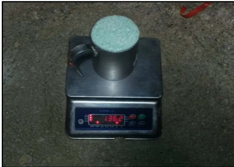
Figura 12. Medición de la densidad inicial en taza de la emulsión G.
