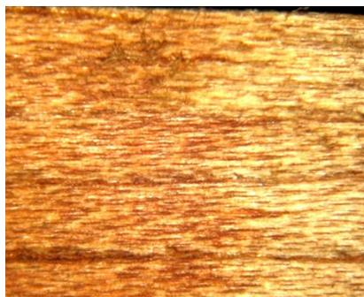
Figura 4.24 Cambio de coloración de la Mohena debido a la absorción del líquido del Agar, se aprecia el desplazamiento del cambio de color.
