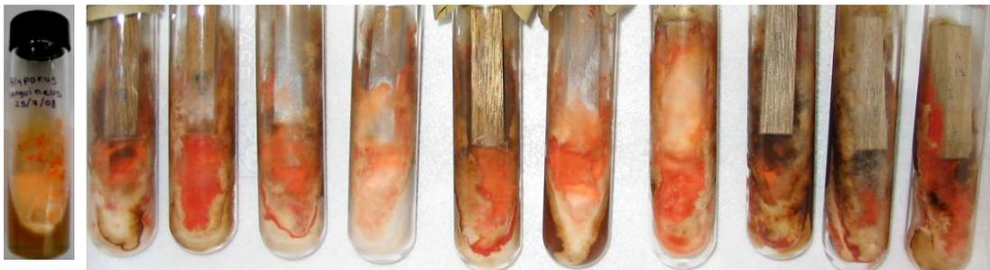
Figura 3.11 Lado izquierdo: el cultivo del hongo *Polyporus sanguineus*. Lado derecho: Las probetas de madera sometidas al ensayo de biodegradación.
