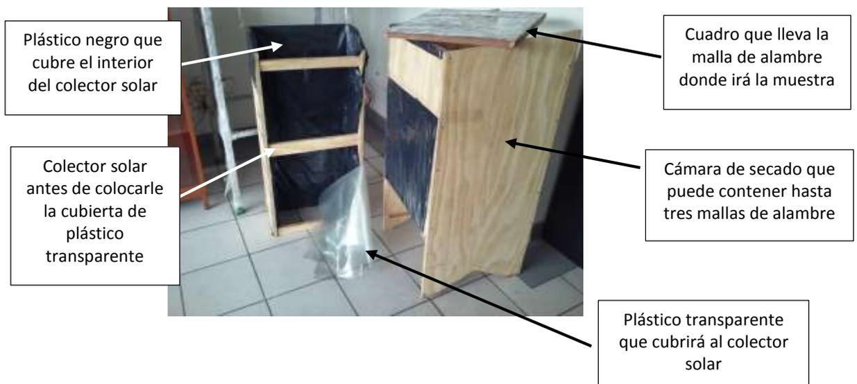
Foto 2.- Para la construcción del secador solar se utilizó una plancha de triplay de 18 mm de espesor 1,22x2,44 metros.
