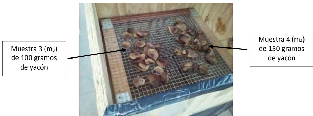
Foto 4.- Inicio de la evaluación del Secador. Se colocaron dos muestras en la primera parrilla de la cámara de secado.
