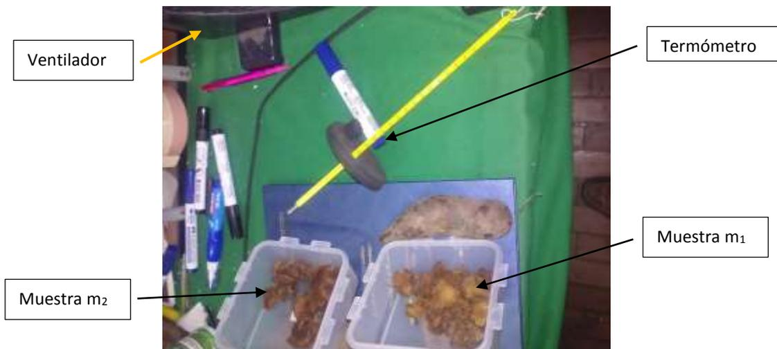
Foto 13.- Determinación de las masas secas de dos muestras iniciales  $m_1 = 150$  gramos y  $m_2 = 100$  gramos utilizando la corriente de aire de un ventilador 220V AC 60 Hz 48 W. Se utilizó la menor velocidad del ventilador (velocidad 1).
