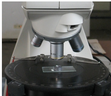
Figura B 2 Muestra colocado sobre una porta muestras en la platina del microscopio.
