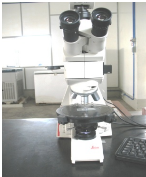
Figura 3 Microscopio Leica Modelo DM750 y una cámara de modelo DFC295
