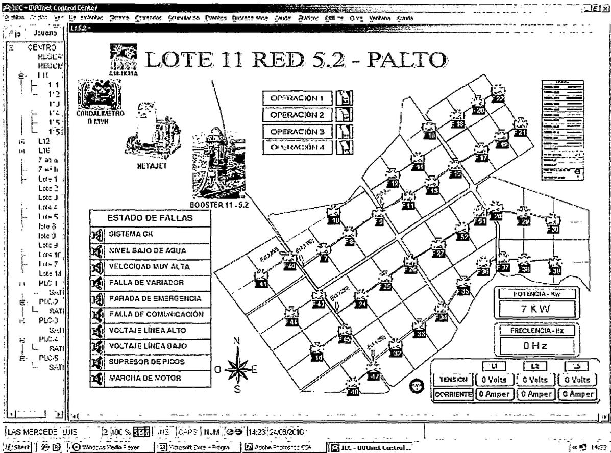
Fig. 5.43 Pantalla del ICC configurado las variables Hidráulicas y Eléctricas
