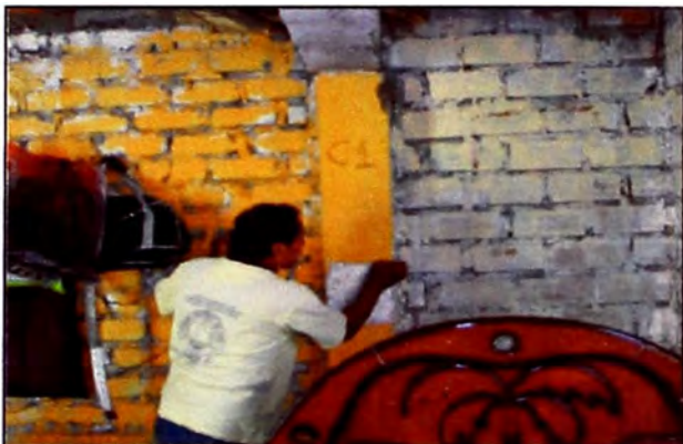
Figura 6.- Se ubica y se hace una limpieza de la superficie donde va a ser aplicado el esclerómetro.
