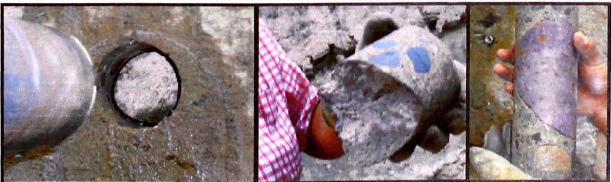
Figura 6.- Se termina de extraer la muestra y se procede a retirarla para dejarla días al aire libre y ensayarla a la compresión.
