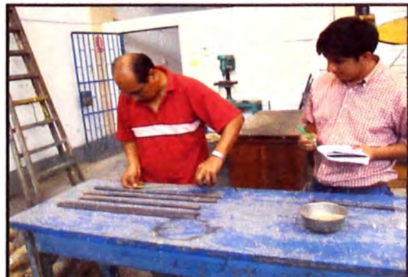
Figura 15.-Se toma los datos de la deformación de la varilla.
