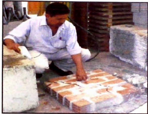
Figura 25. – Verificando el modo de falla.
