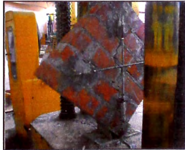
Figura 33. – Se muestra la rotura del murete en forma diagonal. (Fuente: Elaboración propia)
