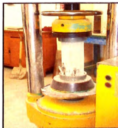
Figura 20 .- Así queda la probeta luego de haber sido aplicado la carga hasta la rotura, con la máquina de compresión. Fuente: (Elaboración propia)
