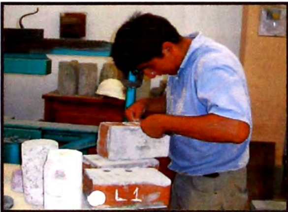
Figura 12.- Ensayo a compresión Simple- ladrillo King- Kong – 18 huecos una vez medido el área en el cual se va a establecer la carga, se procede a colocar en ladrillo en el banco. (Fuente: Elaboración propia)
