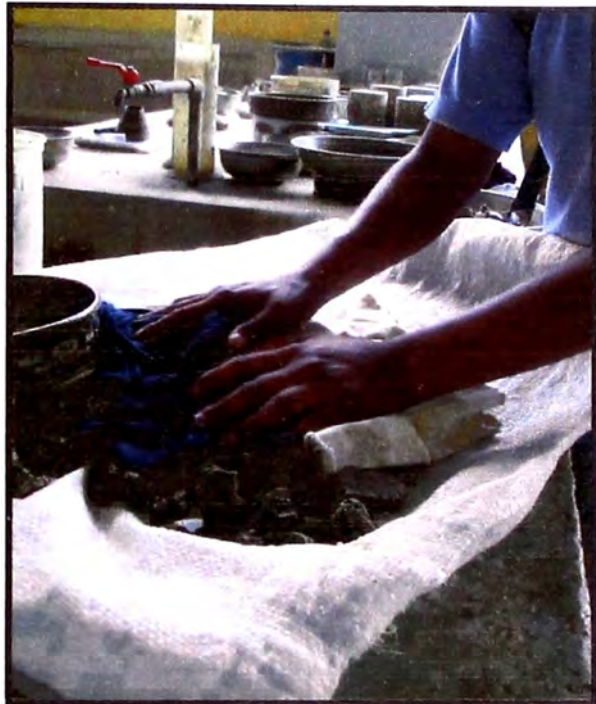
Figura 27. -La muestra tiene que quedar saturado superficialmente seco.(SSS) (Fuente: Elaboración propia)
