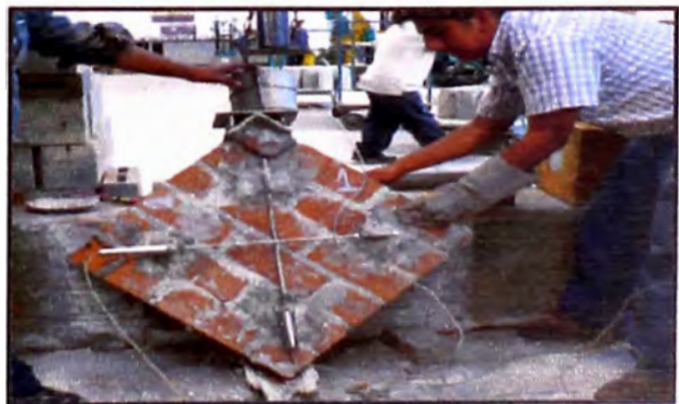
Figura 29. – Murete sometido a la fuerza vertical empieza a fallar.
