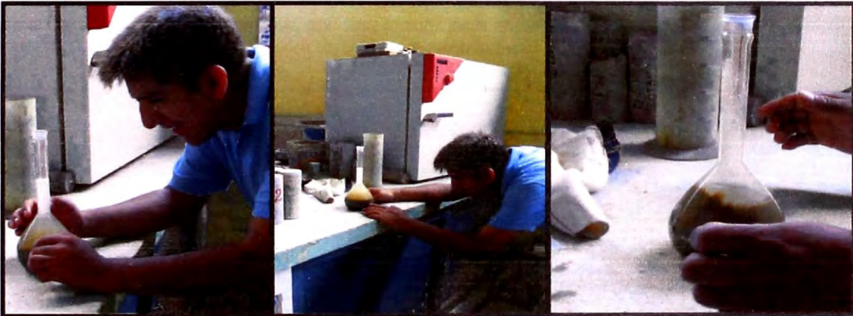
Figura 40. -Luego de eliminar las burbujas, y asegurarnos, que la muestra se encuentre totalmente mojada, se deja reposar, y luego se mide un volumen de 500cc. (Fuente: Elaboración propia)
