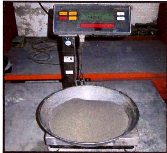
Figura 23.- Se pesa el volumen de arena ocupado en los agujeros. Se procede a los cálculos. (Fuente: Elaboración propia)
