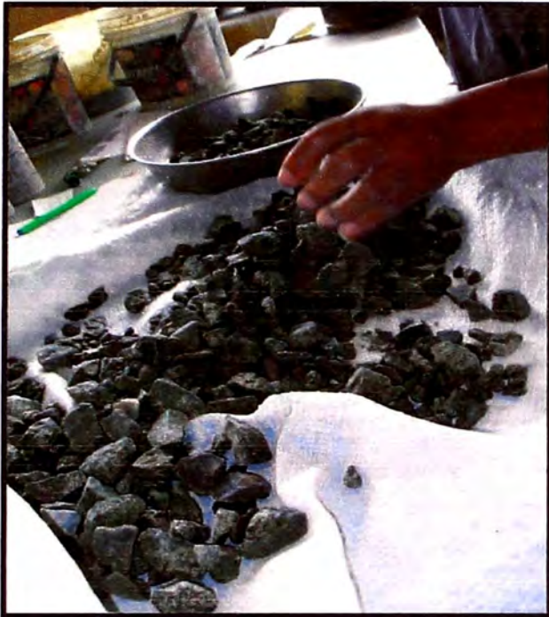
Figura 26. -Se seca la muestra manualmente con una franela. (Fuente: Elaboración propia)
