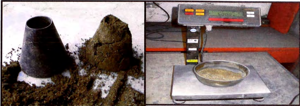
Figura 36. -Una vez llegado al estado saturado superficialmente seco, pesamos una muestra de 500 gramos.
