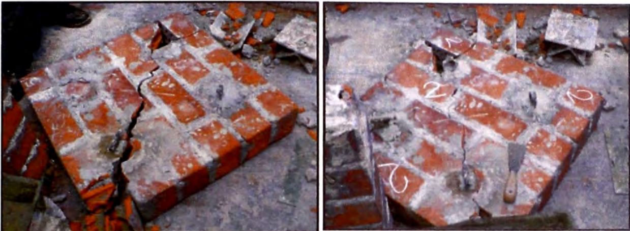
Figura 33. – Se muestra la rotura del murete en forma diagonal. (Fuente: Elaboración propia)
