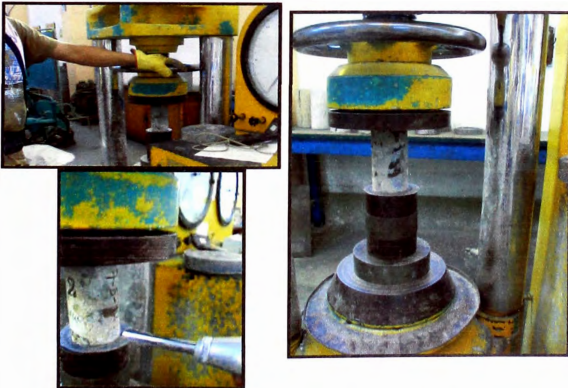
Figura 18.- Colocación de la muestra en la máquina de ensayo a la compresión. Fuente: (Elaboración propia)
