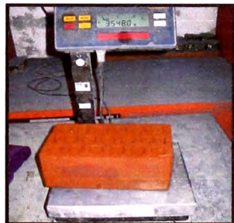
Figura 32.- Se retira el ladrillo de la balanza hidrostática, se seca con un trapo y se obtiene el peso saturado. (Fuente: Elaboración propia)
