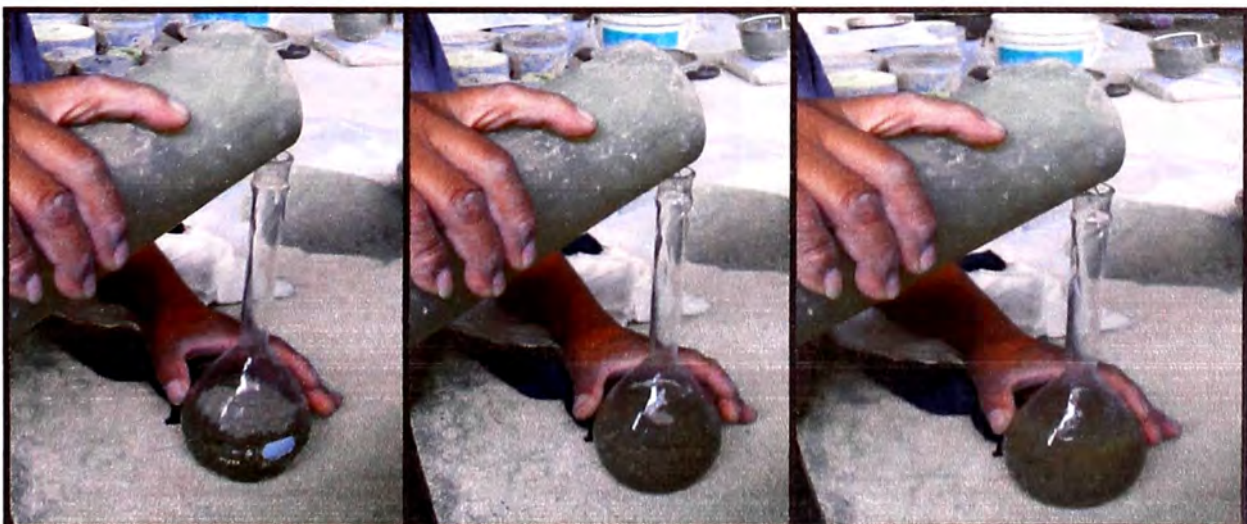
Figura 38. -Llenamos con cuidado agua a la muestra saturada superficialmente seca en la fiola.
