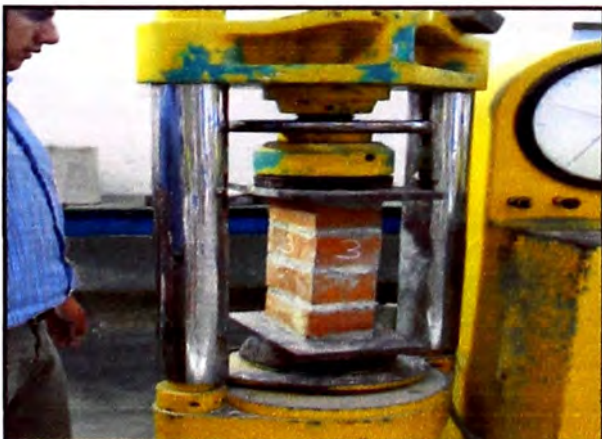
Figura 17.-PILA 3: Siendo sometida a la carga del ensayo de compresión.
