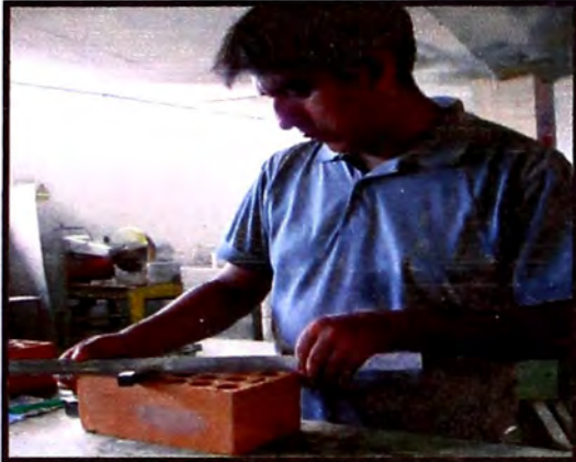
Figura 25.- Se observa que haciendo uso de la cuña metálica y de la regla graduada se puede determinar la distorsión convexa de borde.
