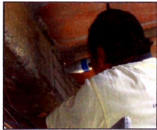
Figura 21. – Se puede notar la viga está siendo aplicada a los disparos del esclerómetro
