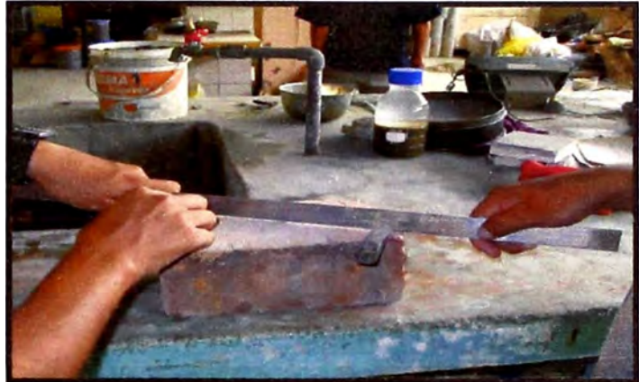
Figura 25.- Se observa que haciendo uso de la cuña metálica y de la regla graduada se puede determinar la distorsión convexa de borde.
