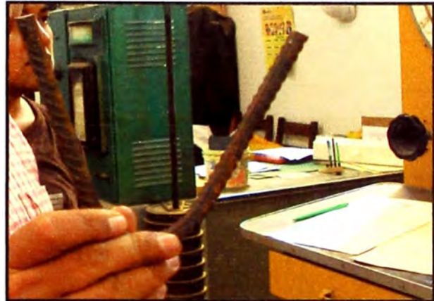
Figura 17.-Se muestra el doblado parcial de la varilla de acero. (Fuente: Elaboración propia)
