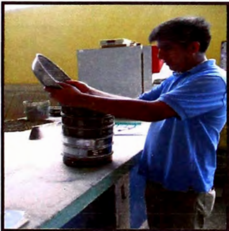
Figura 51. - Se colocan los tamices normalización en orden, luego se coloca la muestra de 500 gramos, y después se lleva a la zaranda mecánica. (Fuente: Elaboración propia)
