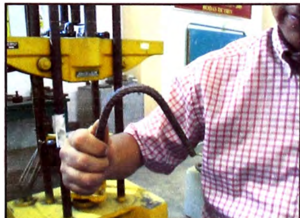
Figura 21.-Aquí se muestra el doblado parcial de la varilla de acero. (Fuente: Elaboración propia)
