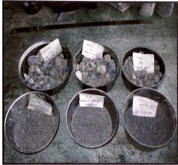
Figura 47.- Muestras de agregado pesadas. Para arena 500gr. Y piedra 1000gr. (Fuente: Elaboración propia)
