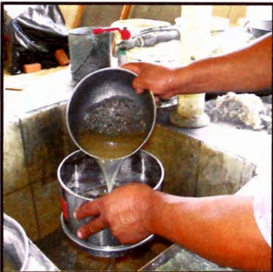
Figura 56.- Se vierte las aguas de lavados en los tamices teniendo cuidado que no se pierdan las partículas. (Fuente: Elaboración propia)
