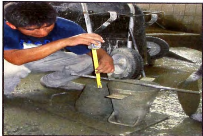
Figura 11.- Se aprecia un slump de 3" Fuente: (Elaboración propia)
