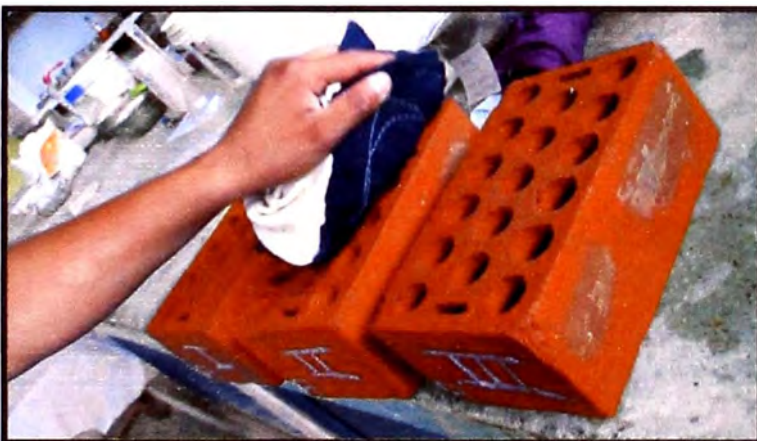
Figura 32.- Se retira el ladrillo de la balanza hidrostática, se seca con un trapo y se obtiene el peso saturado. (Fuente: Elaboración propia)
