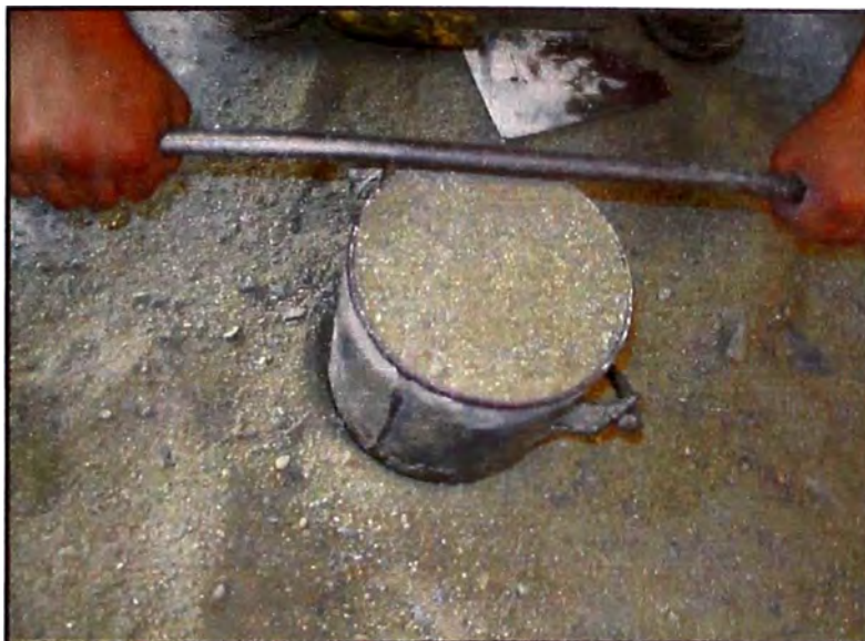
Figura 18. -Al igual que el agregado grueso se hace el vaciado del agregado fino en un balde de 1/10 de pie cúbico, compactado con 25 golpes en 3 capas y enrasado. (Fuente: Elaboración propia)
