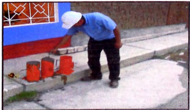
Figura 14.- Se llenan las 3 probetas con concreto para ser ensayadas en laboratorio Fuente: (Elaboración propia)
