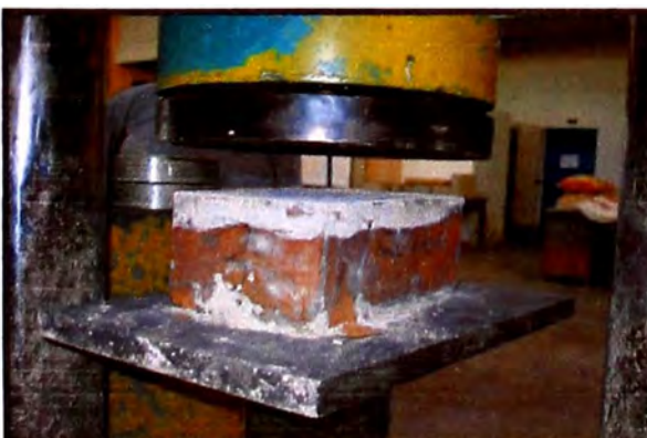
Figura 13.- Capeado de Ladrillos. (Fuente: Elaboración propia)
