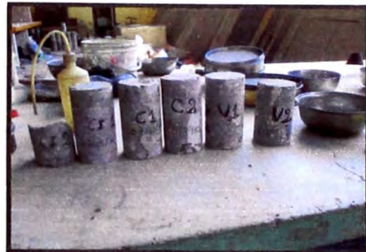
Figura 13 .- Aquí se tienen las muestras en reposo por 7 días para luego ser capeadas.
