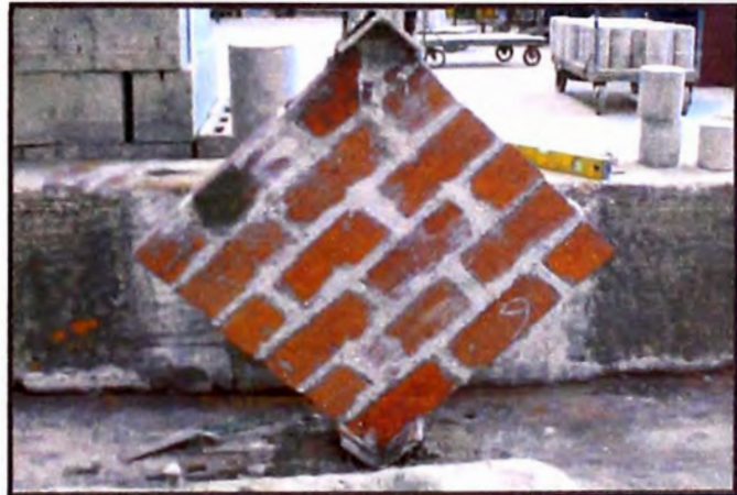
Figura 21. – Forma de corte del murete. (Fuente: Elaboración propia)
