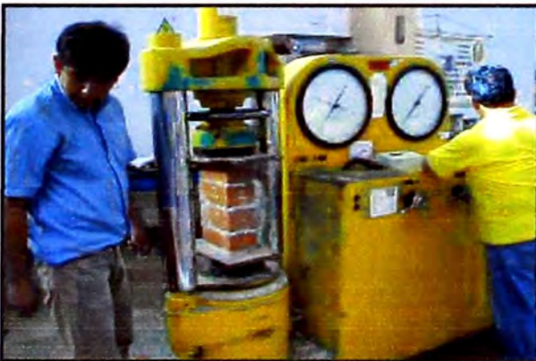
Figura 15.-PILA 2: Durante el ensayo a la compresión.
