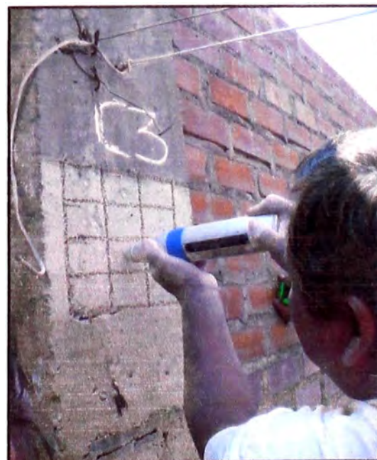
Figura 24. – Realizando el ensayo en la columna C2 instante que marca la lectura el esclerómetro. (Fuente: Elaboración propia)
