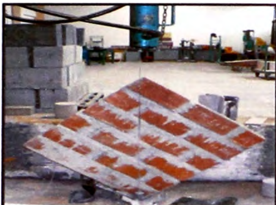
Figura 14. – Murete 1 pandereta. (Fuente: Elaboración propia)
