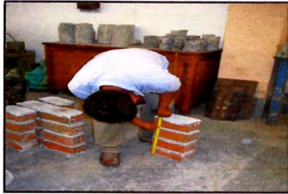
Figura 19.- Es importante realizar las mediciones del área en la cual se va establecer la carga (Fuente: Elaboración propia)
