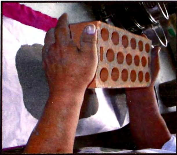
Figura 23.- Se pesa el volumen de arena ocupado en los agujeros. Se procede a los cálculos. (Fuente: Elaboración propia)
