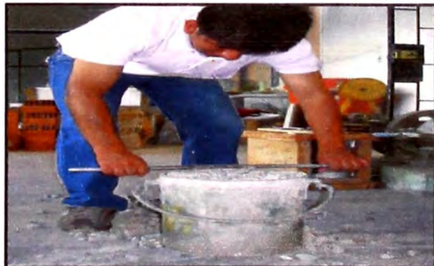
Figura 16. -Enrasado, tratando de que el volumen ocupado por el agregado, se aproxime al volumen del balde. (Fuente: Elaboración propia)
