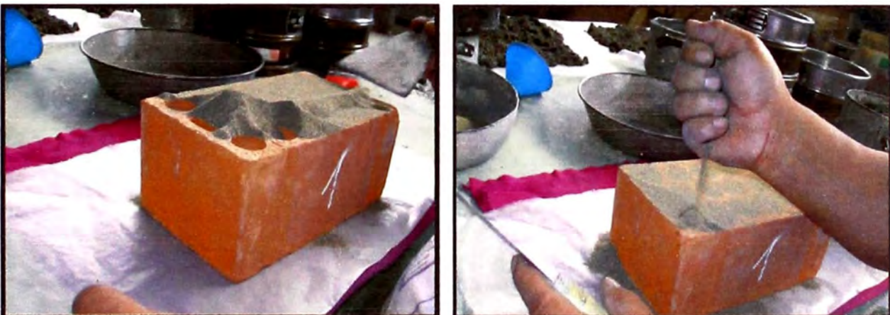
Figura 21.- Este método consiste en introducir arena en los vacíos del ladrillo. (Fuente: Elaboración propia)
