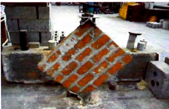
Figura 9.- El murete se llega a romper fallando completamente. (Fuente: Elaboración propia)
