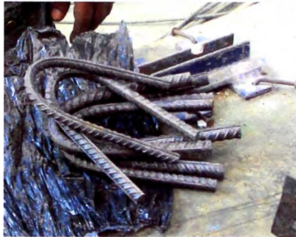
Figura 23. -Las varilla de acero luego de haber sido ensayadas y verificadas.
