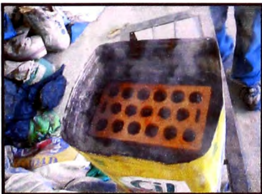
Figura 28.- Los ladrillos se encuentran en el agua hervida a una temperatura aproximada de 100°C
