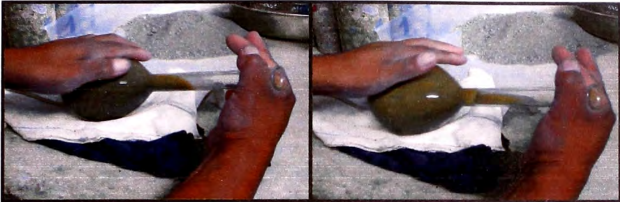
Figura 39. -Colocando una franela debajo de la fiola, se procede a la eliminación de burbujas, rotando la fiola de un lado a otro. (Fuente: Elaboración propia)
