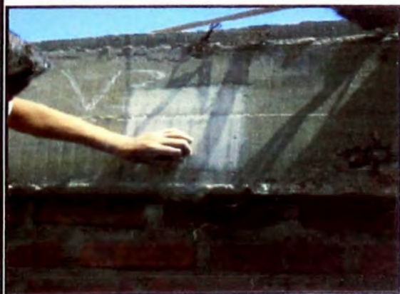
Figura 21. – Se puede notar la viga está siendo aplicada a los disparos del esclerómetro
