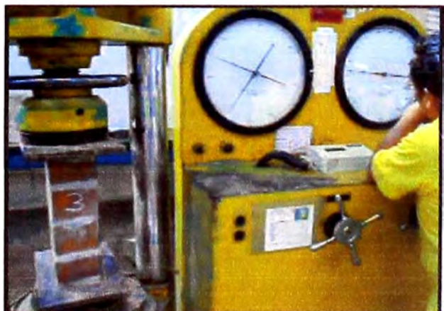
Figura 18.-PILA 3: Instante en que falla la pila de ladrillo
