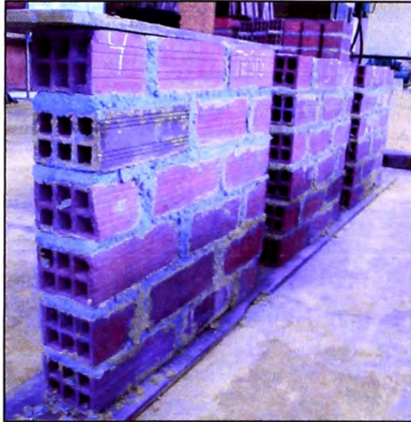
Figura 4.-Murete de ladrillo pandereta (Fuente: Elaboración propia)
