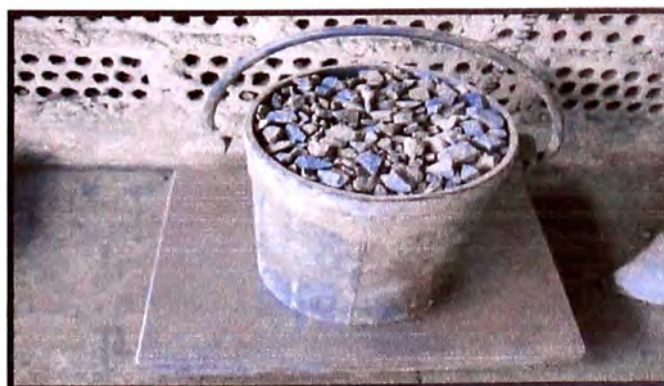
Figura 17. -Pesado del agregado compactado en un volumen de \frac{1}{2} pie cúbico. (Fuente: Elaboración propia)
