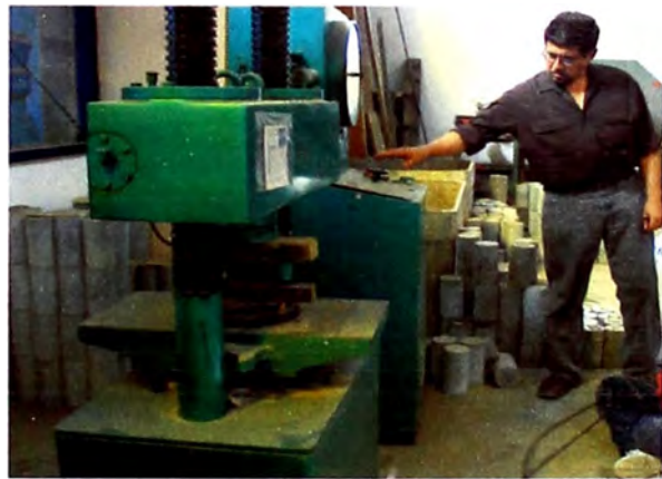
Figura 25. -Varilla de acero de 3/8": Está continuando en ensayo de doblado en la máquina de compresión.
