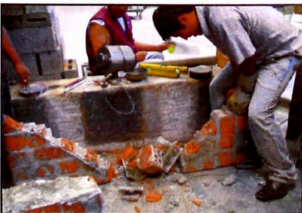
Figura 33. – Aquí ya el murete fallo y se muestra como se llega a romper. (Fuente: Elaboración propia)
