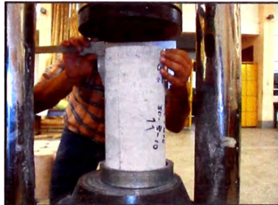
Figura 18 .- Aquí se observa la medición del diámetro de la probeta Fuente: (Elaboración propia)
