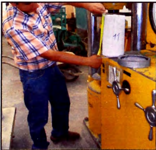
Figura 17 .- Se toma las mediciones de c/u de las probetas Fuente: (Elaboración propia)
