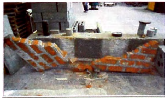
Figura 9.- El murete se llega a romper fallando completamente. (Fuente: Elaboración propia)
