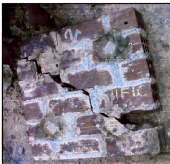
Figura 38. – Aquí se puede ver la forma de falla que tiene el murete.
