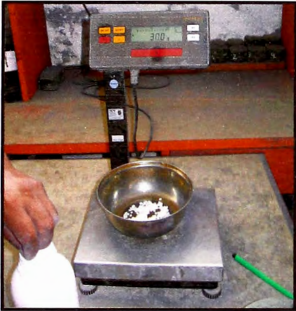
Figura 58.- Se pesa 30 gramos de hidróxido de sodio para luego colocarlos en el recipiente para continuar con el ensayo.
