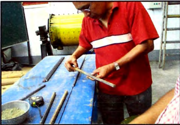
Figura 10.- Varilla de acero de 1/2": Habilitación de las muestras de aceros para ser ensayadas.
