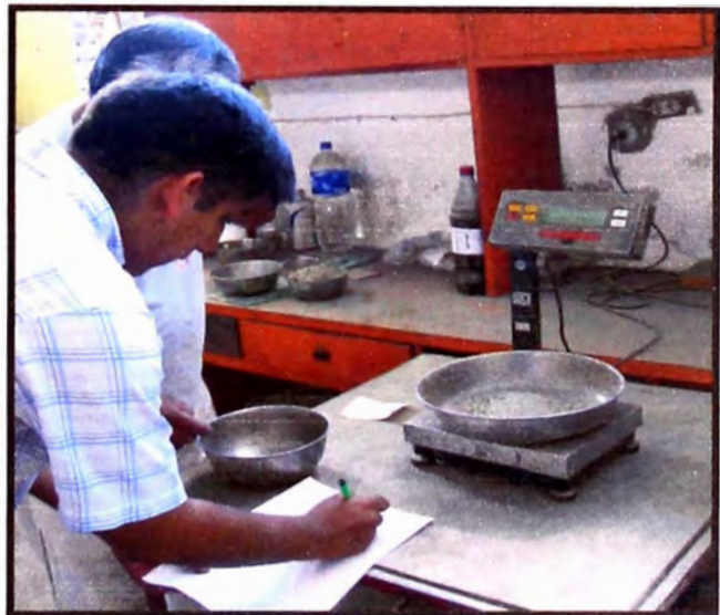
Figura 57.- Se pesa la muestra después del lavado y se toma nota de los resultados. (Fuente: Elaboración propia)
