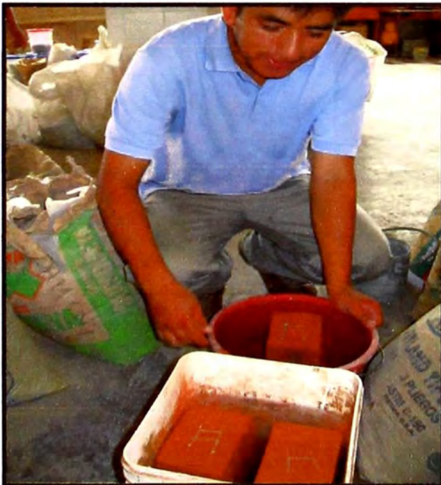
Figura 24.- Saturación de la muestra en un recipiente con agua. (24 hs) (Fuente: Elaboración propia)
