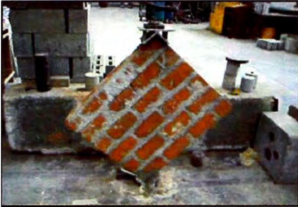
Figura 10.- Murete 2 siendo aplicada la carga vertical. (Fuente: Elaboración propia)
