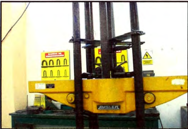
Figura 24. -Varilla de acero de 3/8": siendo sometida al ensayo de doblado.
