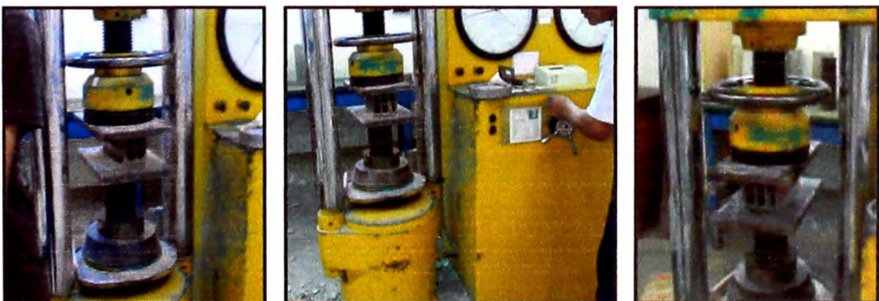
Figura 16.- Estas imágenes son tomadas al finalizar los ensayos en cada ladrillo y se muestra el instante que fallan. (Fuente: Elaboración propia)
