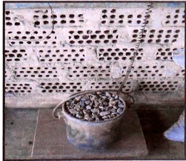
Figura 8.- Pesado del agregado en balanza digital. (Fuente: Elaboración propia)
