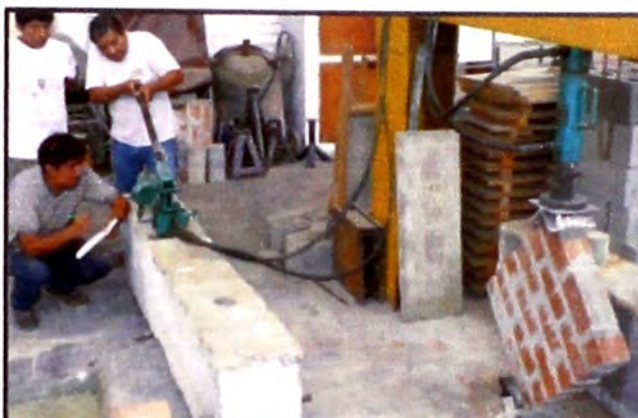
Figura 15. – Lectura de la carga del murete. (Fuente: Elaboración propia)
