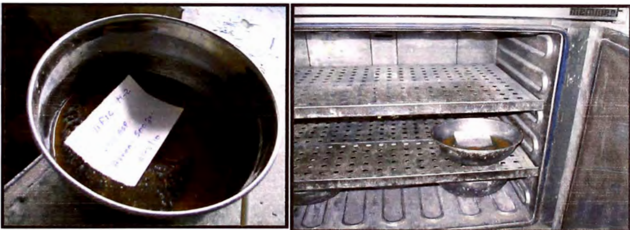
Figura 44. -Colocación de la muestra en un horno para el secado por 24 horas.
