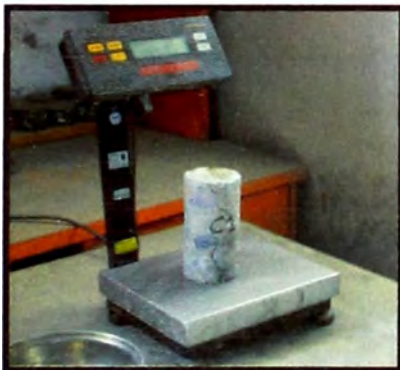
Figura 14 .- Se pesa cada una de las muestras con la balanza electrónica.
