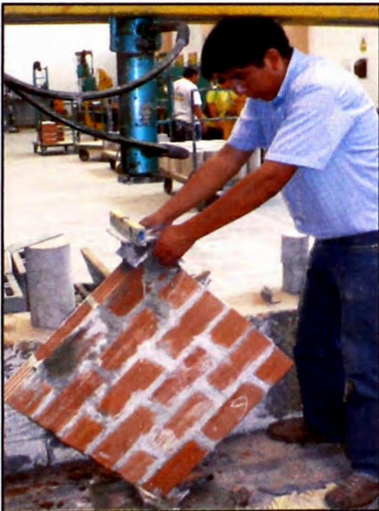
Figura 22. – Murete 3 siendo nivelado y acomodándose para proceder con el ensayo. (Fuente: Elaboración propia)
