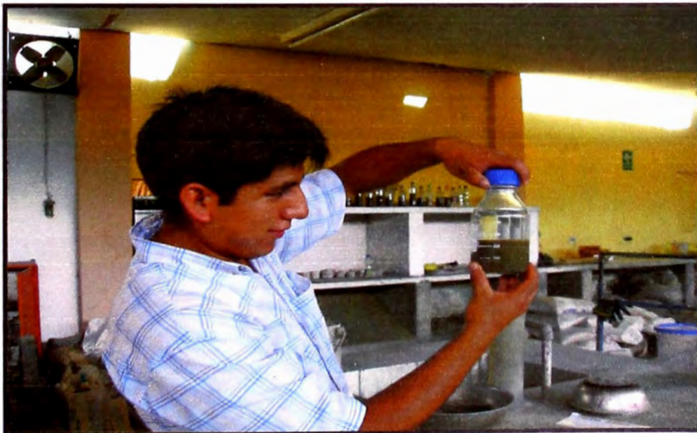
Figura 60.- Se compara con el patrón Gardner N°11 el cual nos podemos dar cuenta que no tiene sustancias orgánicas.
