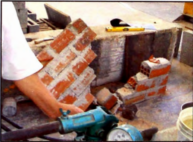
Figura 20. – Instante de la rotura de murete. (Fuente: Elaboración propia)
