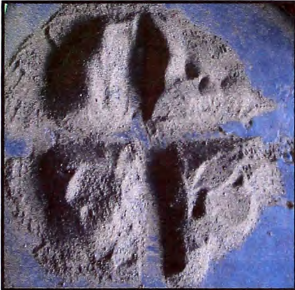
Figura 46.- Cuarteo del material y extracción de la muestra. (Fuente: Elaboración propia)
