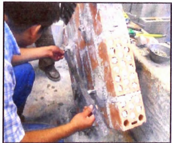
Figura 32. – Medición de los extensiómetros. (Fuente: Elaboración propia)
