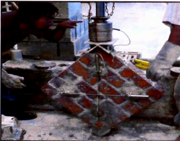
Figura 31. – Murete 2 listo para ser ensayado. (Fuente: Elaboración propia)
