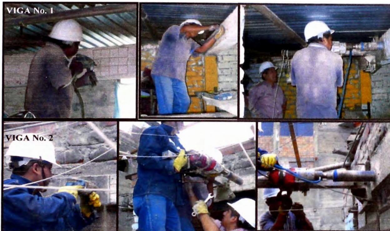
Figura 10.- Se ubica el lugar donde se va extraer la muestra de concreto para lo cual se esta colocando pernos de anclaje y se procede a instalar el equipo. Fuente: (Elaboración propia)
