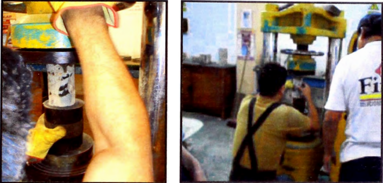
Figura 18.- Colocación de la muestra en la máquina de ensayo a la compresión. Fuente: (Elaboración propia)
