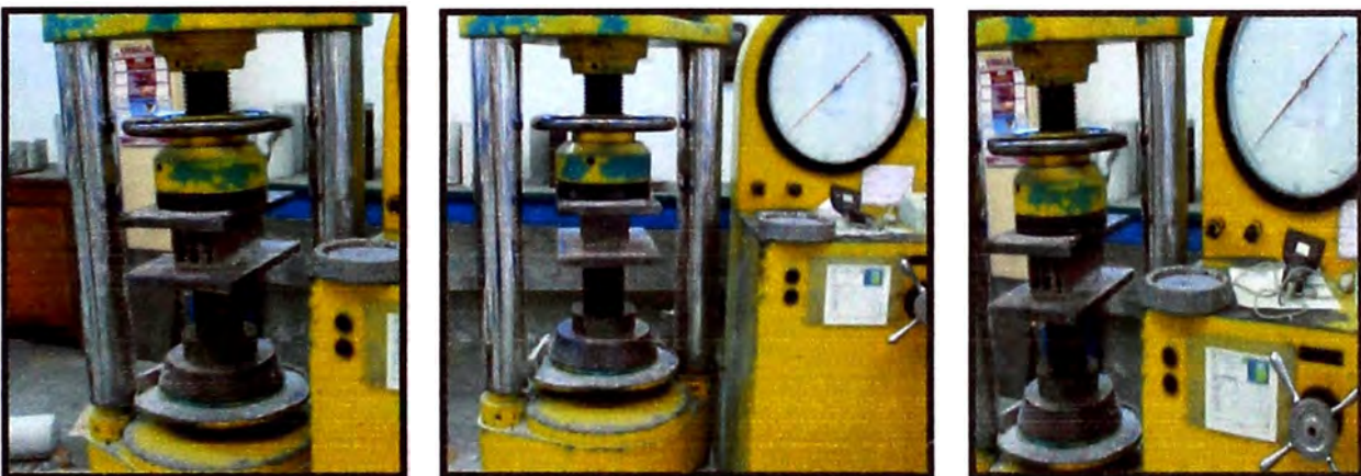
Figura 15.- Aquí se muestran las tres muestras de ladrillo pandereta que están siendo sometidas a la carga por la máquina de compresión. (Fuente: Elaboración propia)
