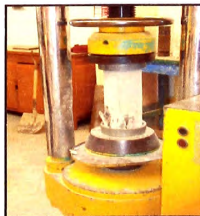
Figura 20 .- Así queda la probeta luego de haber sido aplicado la carga hasta la rotura, con la máquina de compresión. Fuente: (Elaboración propia)
