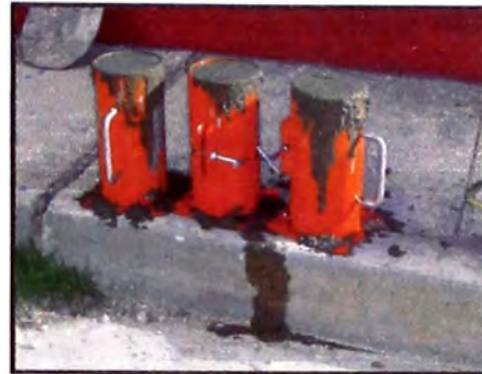
Figura 16 .- Se muestran las 3 probetas tomadas en obra. Fuente: (Elaboración propia)
