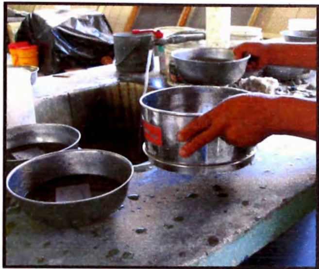
Figura 55.- Se agrega el material sobre el recipiente y se agrega agua (Fuente: Elaboración propia)
