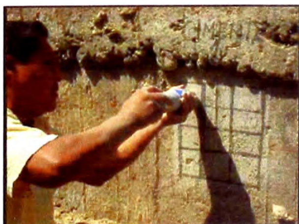
Figura 16. – Haciendo los disparos con el esclerómetro en la cimentación. (Fuente: Elaboración propia)
