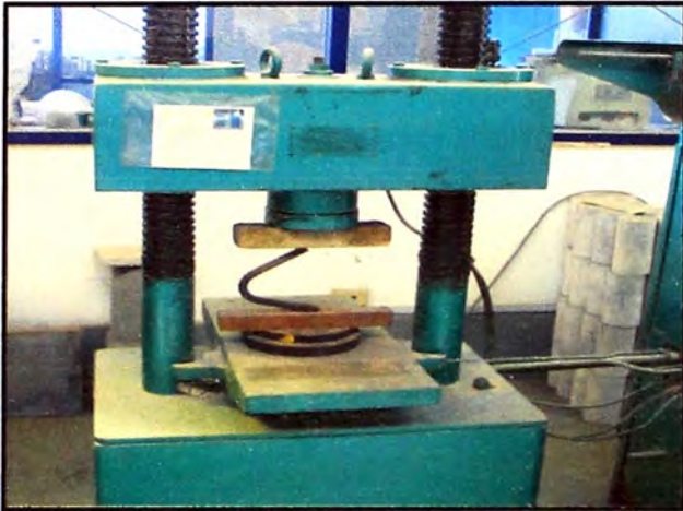
Figura 22. -Continuando con el ensayo de doblado se somete a la máquina de compresión.
