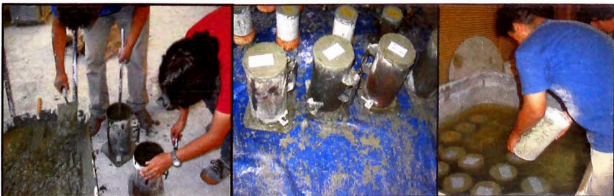
Figura 4.- Después de llenar las probetas de concreto se deja que seque 24 horas, para luego desmoldarlas. . (Fuente: Elaboración propia)
