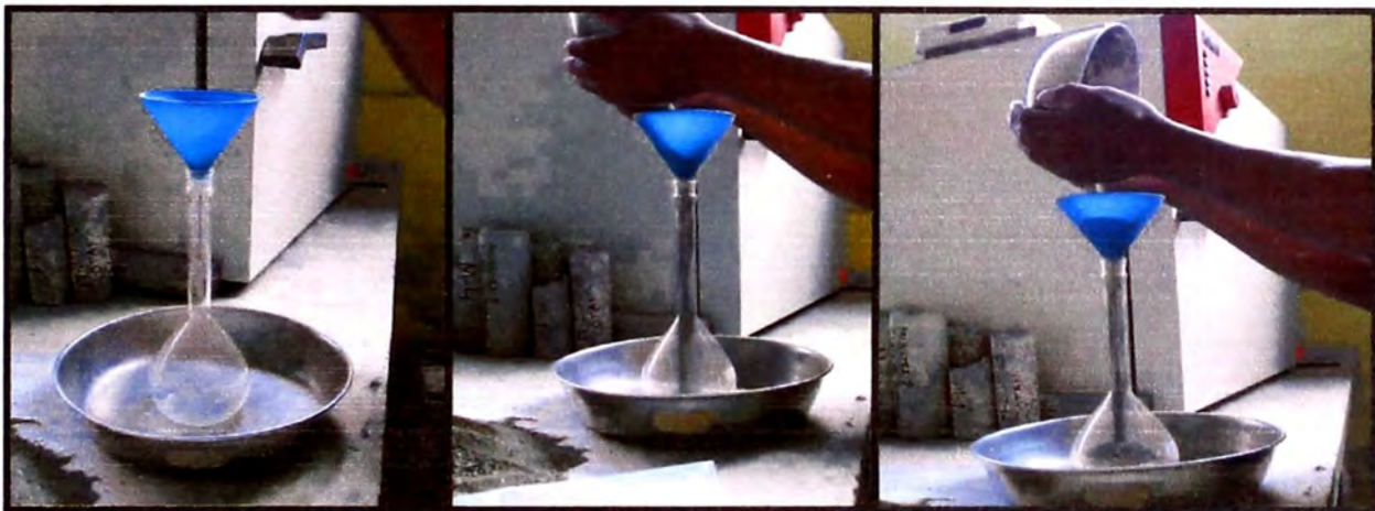
Figura 37. -Introducir la muestra saturada superficialmente seca en la fiola.
