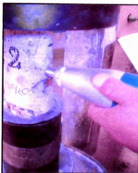
Figura 5.- Muestra de testigo diamantino en compresión calibrando el martillo (Fuente: Elaboración propia)
