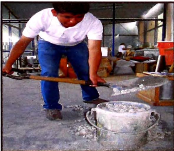
Figura 7.- Vaciado del agregado sin compactar, en un balde de medio pie cúbico. (Fuente: Elaboración propia)
