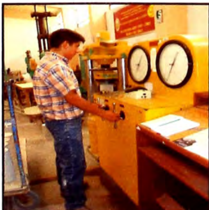
Figura 19 .- Se aplica la carga con la máquina de compresión. Fuente: (Elaboración propia)
