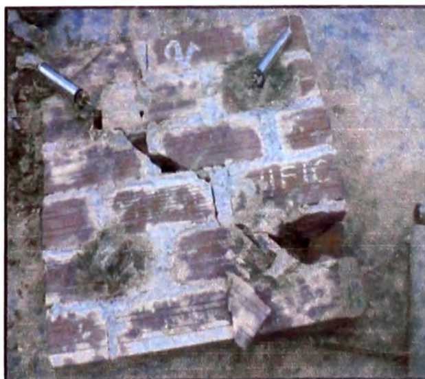
Figura 38. – Aquí se puede ver la forma de falla que tiene el murete.
