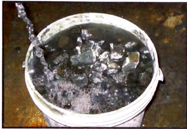
Figura 21.-Saturación del agregado con agua. (Fuente: Elaboración propia)
