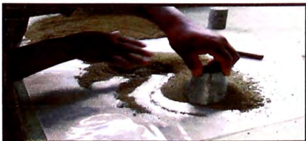
Figura 35.-Para determinar si la muestra se encuentra en estado SSS se utiliza la prueba del cono, en el cual la muestra se encuentra en estado SSS cuando al retirar el cono, la muestra apenas se sostiene, y parte de ella se ha desmoronado. Si la muestra queda perfecta sin desmoronarse, entonces todavía no está lista, y tiene que dejar secar más tiempo. (Fuente: Elaboración propia)
