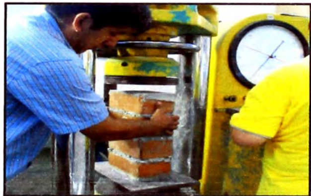
Figura 16.-PILA 2: Después del ensayo de compresión.
