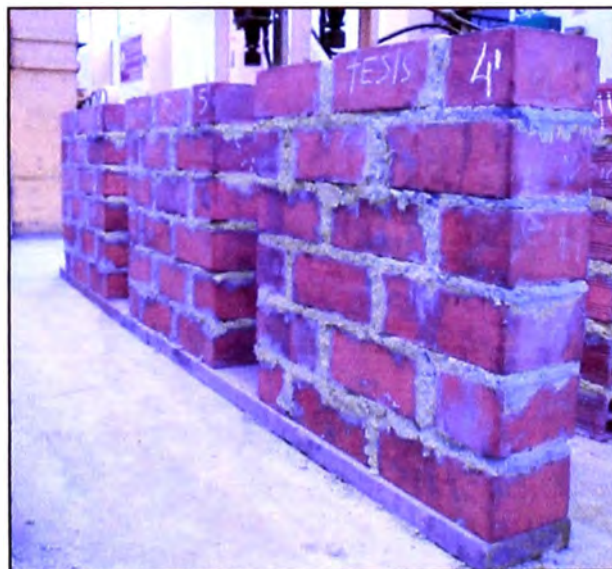
Figura 3.- Murete de ladrillo King Kong de 18 huecos (Fuente: Elaboración propia)
