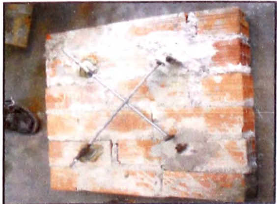
Figura 43. – Aquí se muestra la forma de falla para este murete 3. (Fuente: Elaboración propia)
