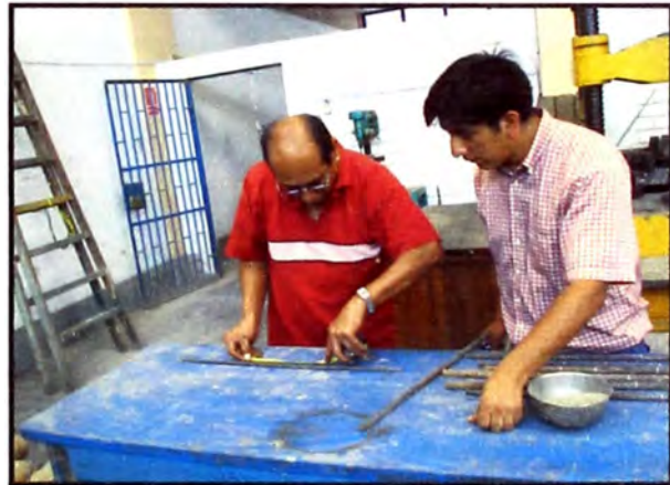
Figura 13.-Varilla de acero de 3/8": Habilitación de las muestras de acero para ser ensayados.
