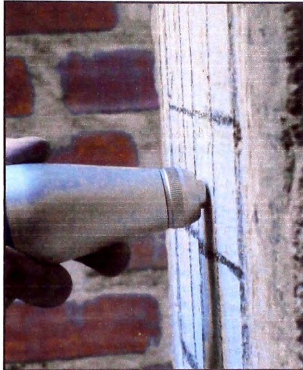
Figura 24. – Realizando el ensayo en la columna C2 instante que marca la lectura el esclerómetro. (Fuente: Elaboración propia)
