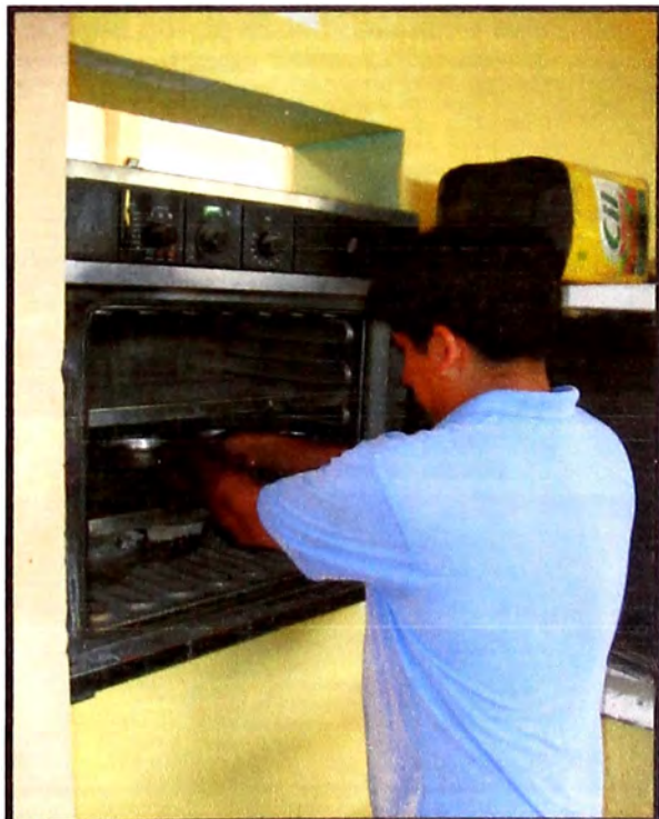
Figura 29. -Luego se coloca al horno 24 horas, luego se pesa la muestra seca. (Fuente: Elaboración propia)
