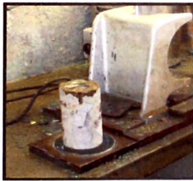
Figura 15 .- Se procede con el capeado aplicando una mezcla de azufre y bentonita.
