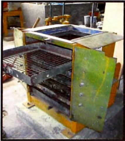
Figura 49. -Maquina "zaranda mecánica" para el agregado grueso (Fuente: Elaboración propia)
