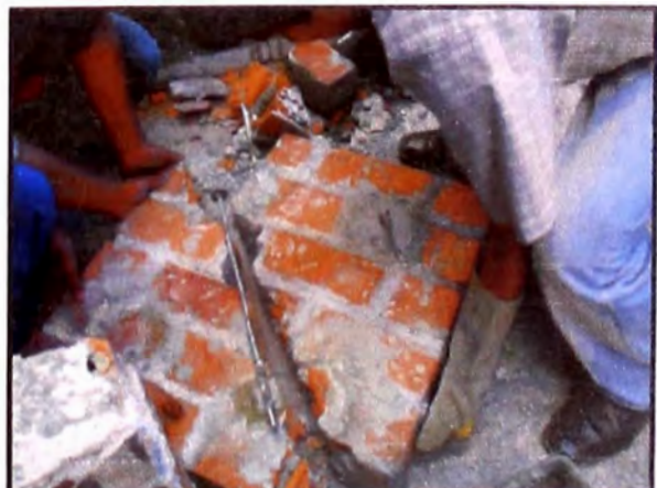
Figura 33. – Aquí ya el murete fallo y se muestra como se llega a romper. (Fuente: Elaboración propia)
