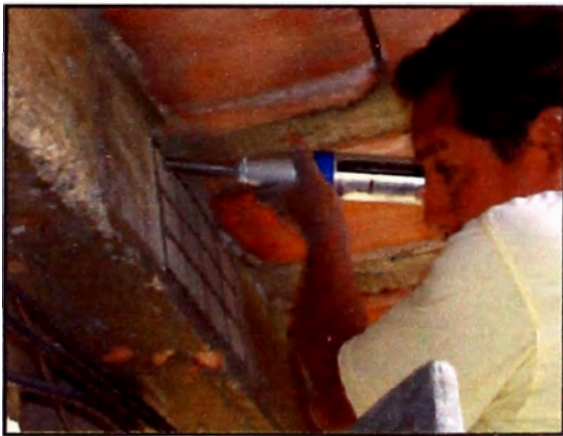
Figura 21. – Se puede notar la viga está siendo aplicada a los disparos del esclerómetro
