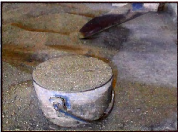
Figura 11.- Vaciado del agregado fino en un balde de 1/10 de pie cubico. (Fuente: Elaboración propia)
