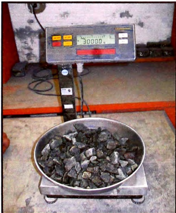
Figura 28. -Se pesa 3 kilos de muestra saturado superficialmente seco. (Fuente: Elaboración propia)
