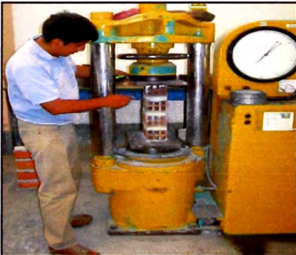
Figura 20.- Ensayo a compresión muestra1 antes y después de ser ensayado. (Fuente: Elaboración propia)
