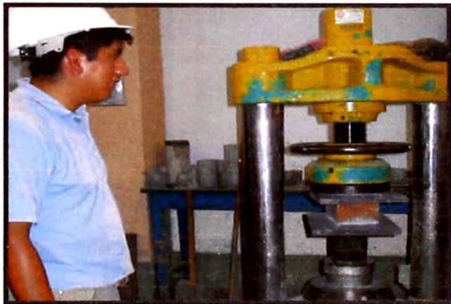
Figura 12.- Ensayo a compresión Simple- ladrillo King- Kong – 18 huecos una vez medido el área en el cual se va a establecer la carga, se procede a colocar en ladrillo en el banco. (Fuente: Elaboración propia)
