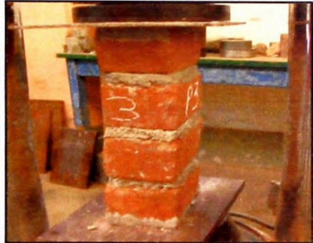
Figura 5.-Ensayo de pila de ladrillo king-
