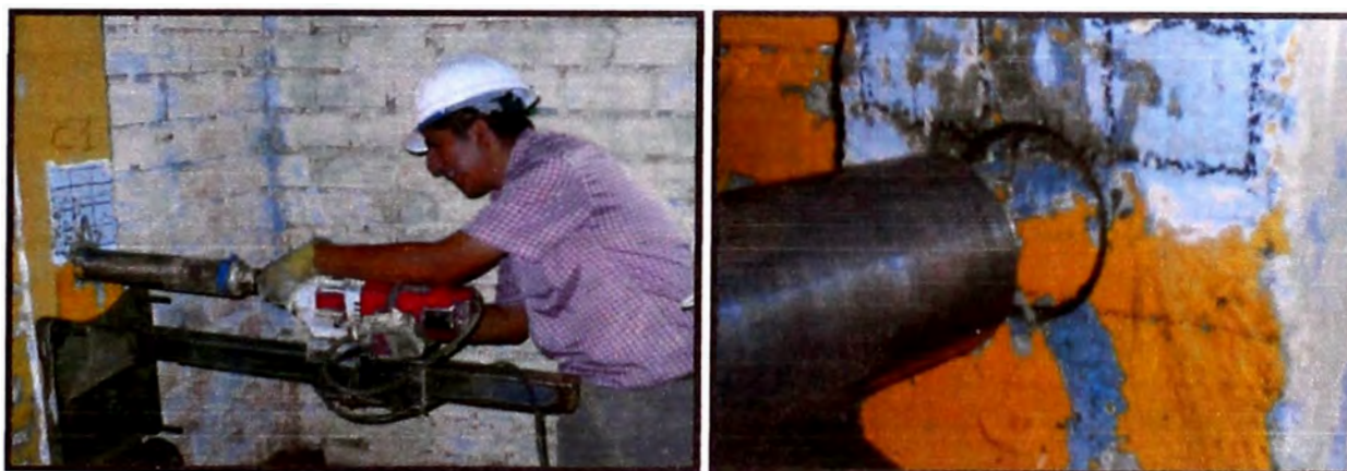
Figura 8.- Aquí se puede ver proceso d la extracción de la muestra aplicando el equipo Fuente: (Elaboración propia)
