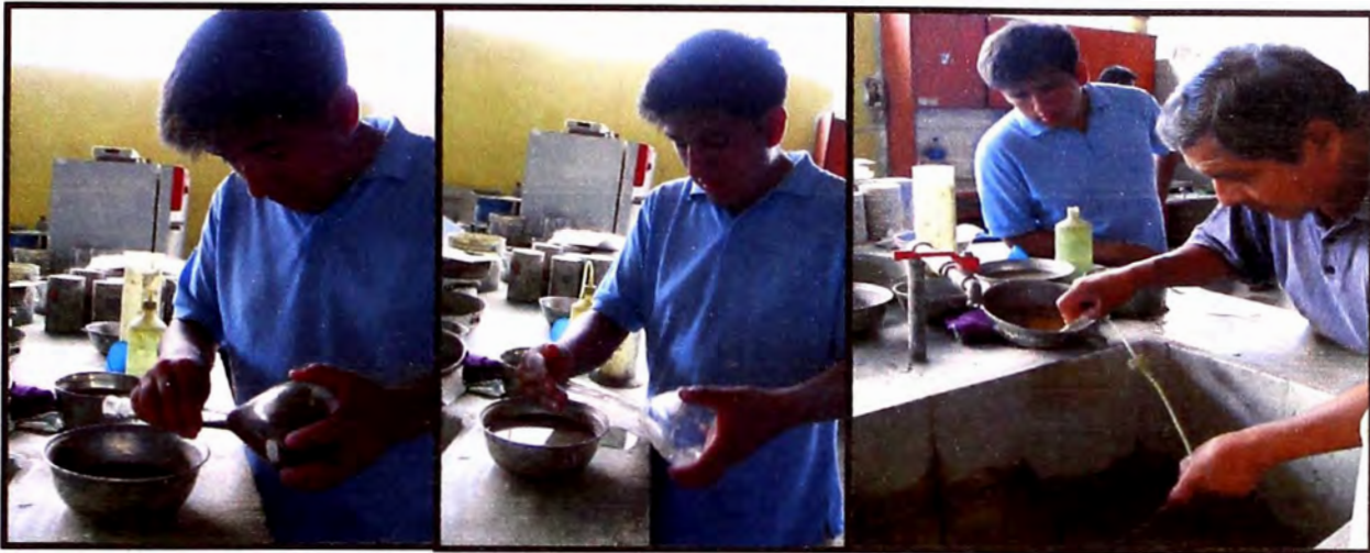
Figura 43. -Vaciamos la muestra en un recipiente, dejamos reposar 5 minutos, para luego extraer el agua de la superficie, con una manguerita. Asegurándonos de que solo se extraiga agua mas no arena.
