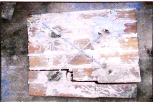
Figura 43. – Aquí se muestra la forma de falla para este murete 3. (Fuente: Elaboración propia)
