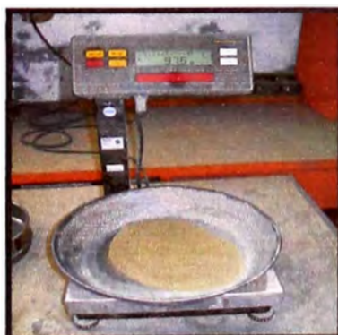
Figura 53. - Luego se pesa, lo retenido por cada tamiz. (Fuente: Elaboración propia)
