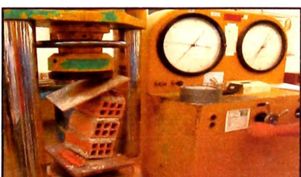
Figura 21.- Ensayo a compresión muestra 2 en el instante de rotura. Se observa la falla del ladrillo ubicado en la parte superior. (Fuente: Elaboración propia)
