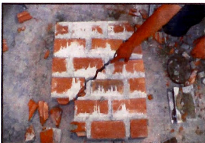
Figura 16. – Rotura del murete de ladrillo. (Fuente: Elaboración propia)
