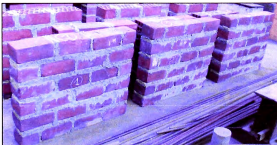
Figura 1.- Murete de ladrillo macizo (Fuente: Elaboración propia)
