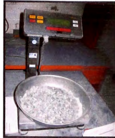
Figura 50. - Una vez zarandeado, se procede a pesar lo retenido en los diferentes tamices. (Fuente: Elaboración propia)
