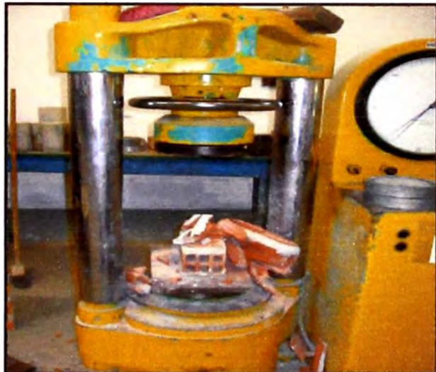
Figura 20.- Ensayo a compresión muestra1 antes y después de ser ensayado. (Fuente: Elaboración propia)
