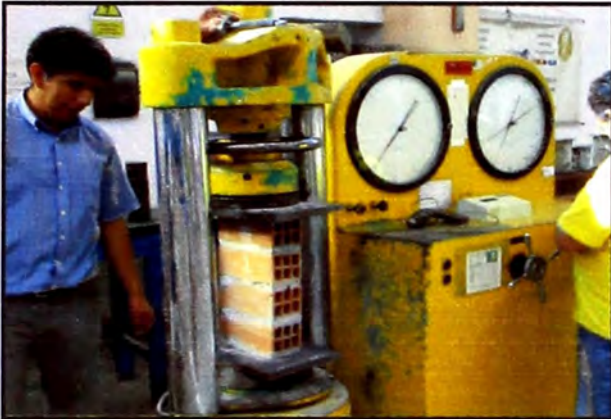
Figura 9.- PILA 1: Colocándose en la máquina de compresión para ser ensayada. (Fuente: Elaboración propia)
