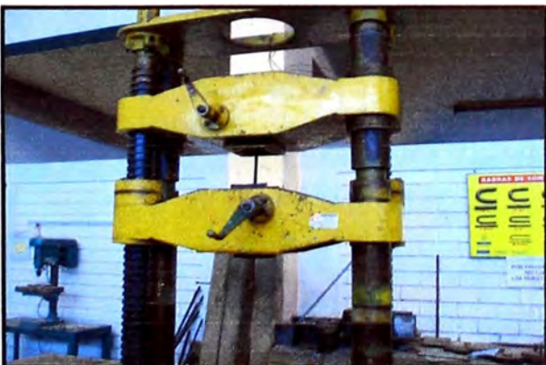
Figura 14.-La varilla de acero de 3/8": sometido a la fuerza de tracción.
