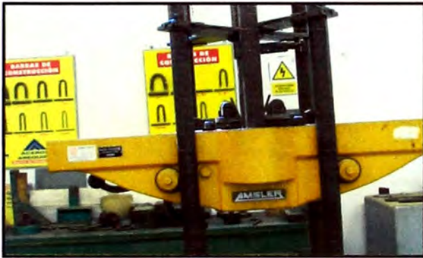
Figura 18.-Aquí se muestra la varilla siendo sometida a la máquina de compresión para continuar el doblado. (Fuente: Elaboración propia)
