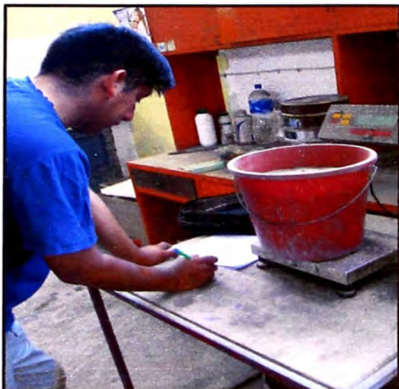
Figura 6.- Se hace la medición de cada uno de los componentes de concreto. Fuente: (Elaboración propia)
