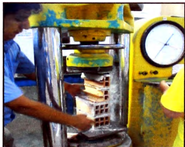
Figura 12.- PILA 2: aqui se puede ver como falla la pila y se procede a retirarla. (Fuente: Elaboración propia)
