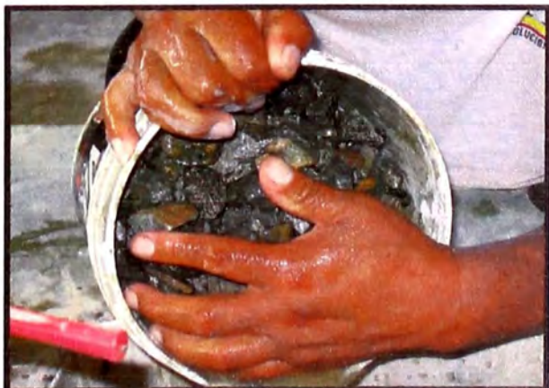
Figura 25.-Luego de saturar la muestra, vaciamos sobre una superficie, de preferencia plástica. (Fuente: Elaboración propia)
