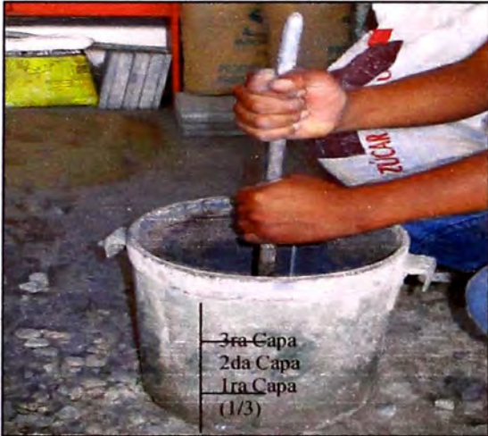
Figura 13. -Compactado del agregado en tres capas de 25 golpes cada una. (Fuente: Elaboración propia)
