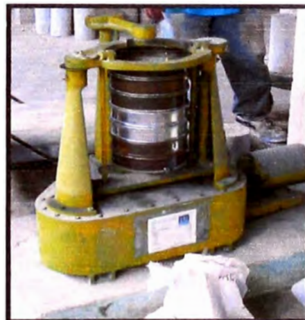
Figura 52. - Maquina "zaranda mecánica" para el agregado fino por vibrado. (Fuente: Elaboración propia)
