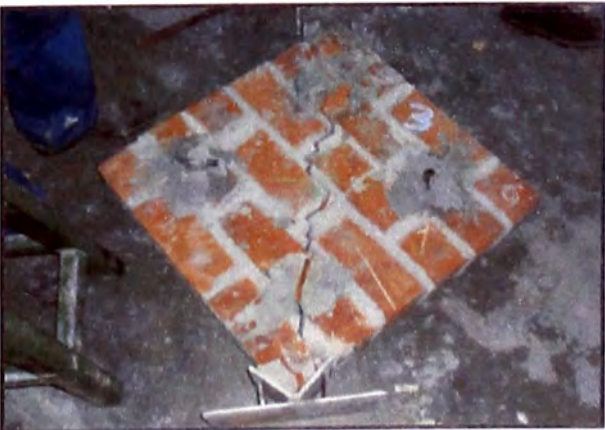
Figura 35. – Forma de falla diagonal del murete 3.
