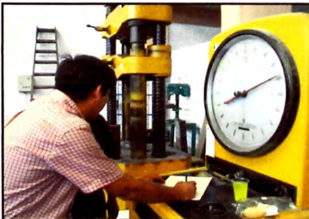
Figura 8.-Varilla de acero. Está siendo aplicada la carga para este ensayo. (Fuente: Elaboración propia)
