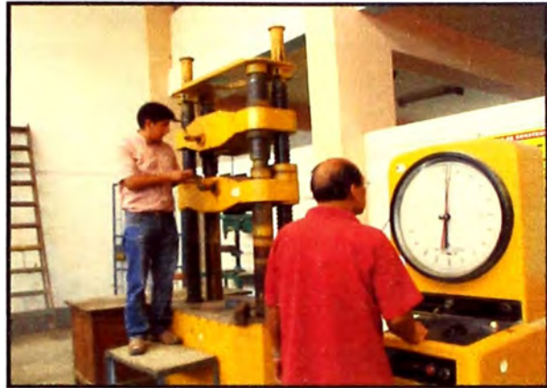
Figura 11.-Varilla de acero de 1/2": sometida al esfuerzo de tracción.
