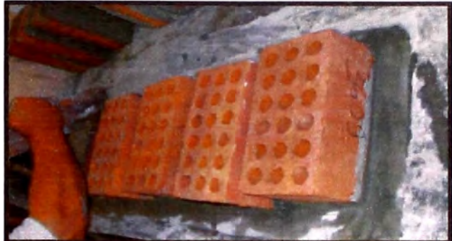
Figura 11.- Capeado de Ladrillos. (Fuente: Elaboración propia)
