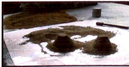
Figura 35.-Para determinar si la muestra se encuentra en estado SSS se utiliza la prueba del cono, en el cual la muestra se encuentra en estado SSS cuando al retirar el cono, la muestra apenas se sostiene, y parte de ella se ha desmoronado. Si la muestra queda perfecta sin desmoronarse, entonces todavía no está lista, y tiene que dejar secar más tiempo. (Fuente: Elaboración propia)
