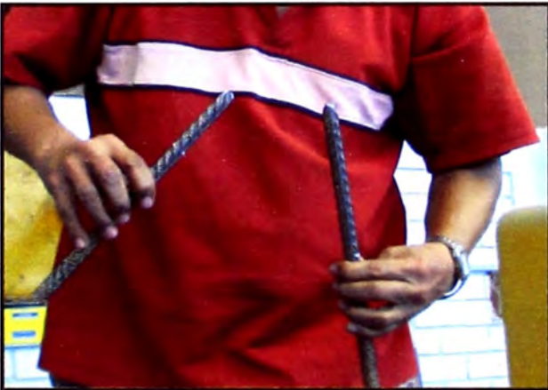
Figura 12.-Varilla de acero de 1/2": se muestra cómo y por donde fallo.
