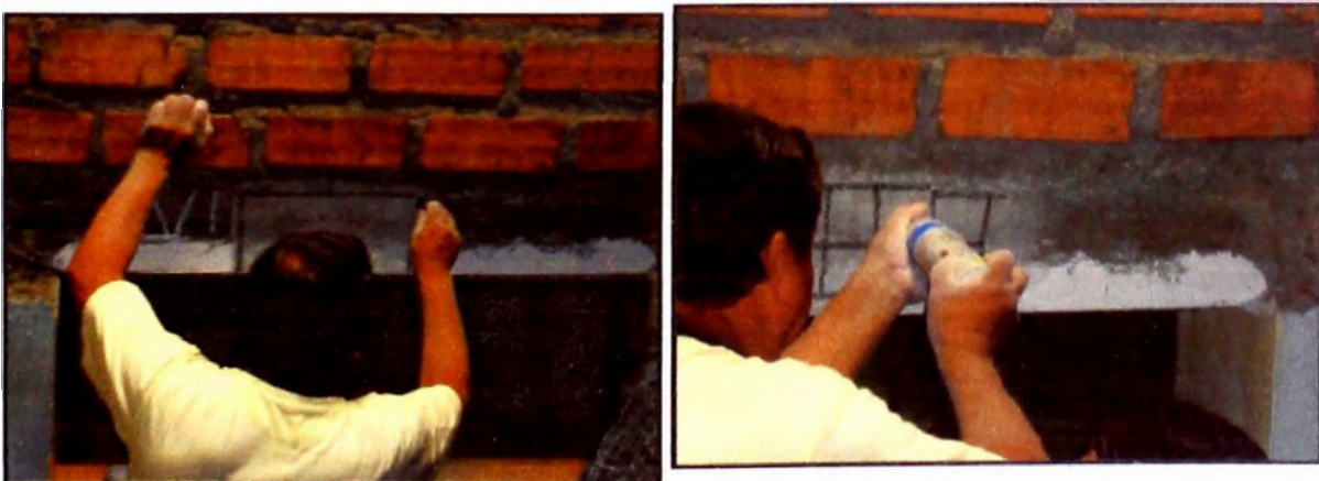
Figura 24. – La columna C1 siendo aplicada de los disparos por el esclereometro (Fuente: Elaboración propia)
