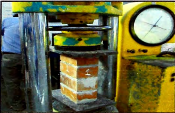
Figura 13.-PILA 1: Durante el ensayo de compresión
