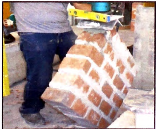
Figura 13. Murete 3: Colocación del murete y nivelación en la máquina para ser ensayado. (Fuente: Elaboración propia)
