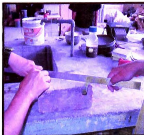
Figura 2.- Medición del alabeo con una cuña y regla (Fuente: Elaboración propia)
