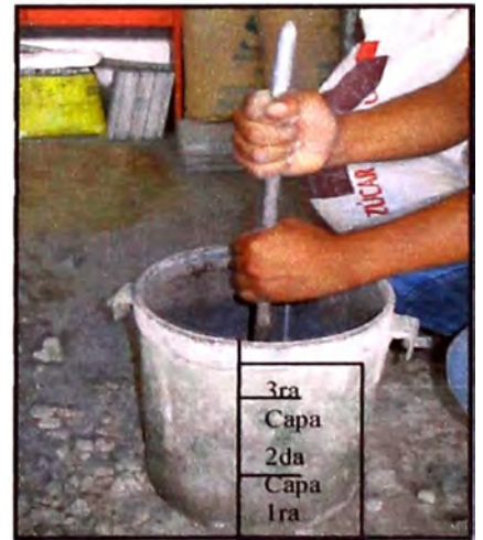
Figura 1.- Compactación de la muestra en 3 capas de 25 golpes cada una (Fuente: Elaboración propia)
