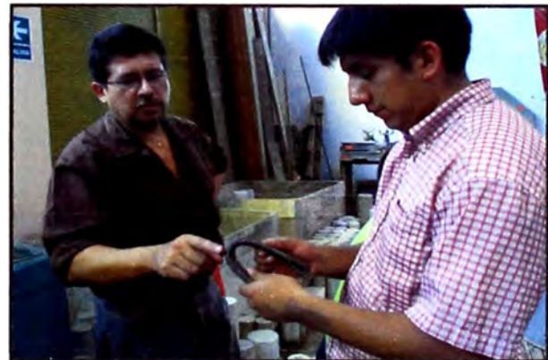
Figura 19.-Verificando si hay alguna fisura luego del doblado. (Fuente: Elaboración propia)
