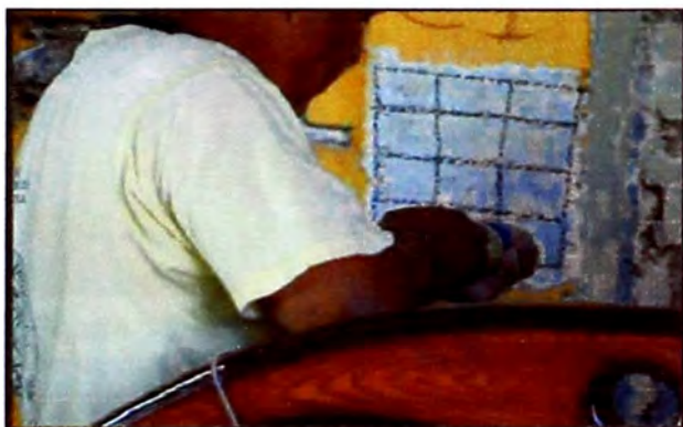
Figura 8.- Aquí se termina de hacer el último disparo en la columna.
