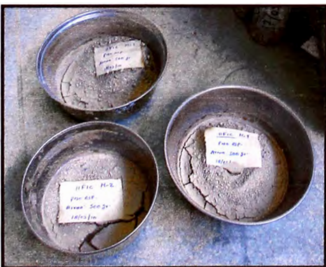
Figura 44. -Colocación de la muestra en un horno para el secado por 24 horas.
