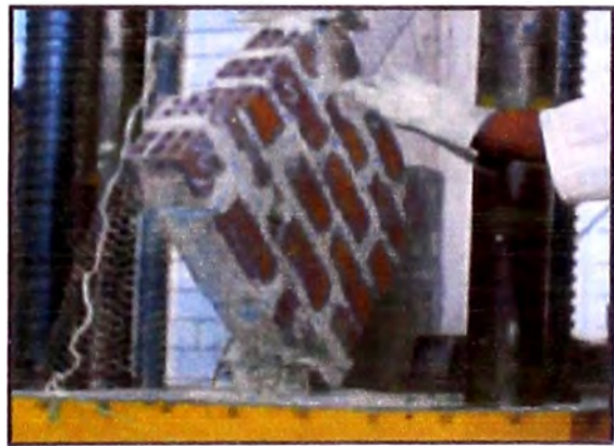
Figura 42. – Aquí ya se observa el murete en el instante que falla. (Fuente: Elaboración propia)
