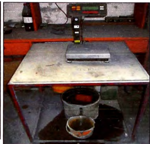
Figura 31.- Pesado del ladrillo sumergido. (Fuente: Elaboración propia)
