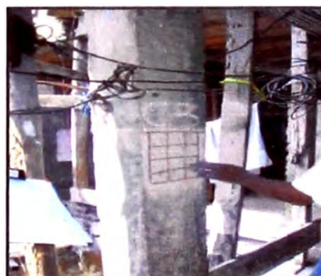
Figura 19. — Columna C3 terminado de hacer los disparos con el esclerómetro. (Fuente: Elaboración propia)
