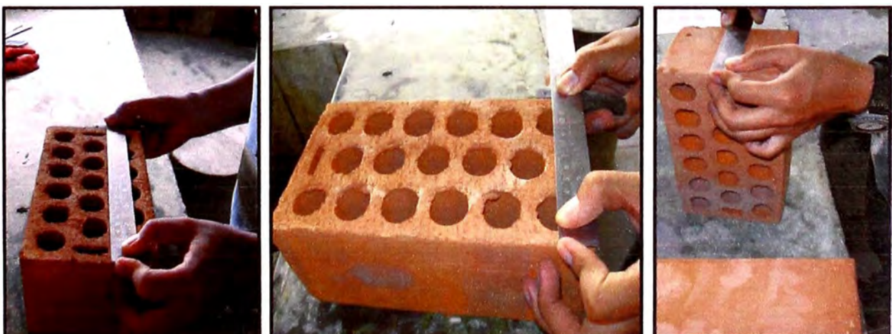
Figura 19.- En este ensayo se hace la medición de los lados de los ladrillos de las 3 muestras de cada tipo de ladrillo para determinar la variación dimensional que se tienen. (Fuente: Elaboración propia)
