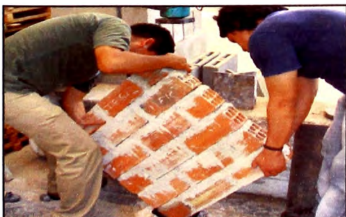
Figura 18. – Murete 2 se coloca el murete en la posición adecuada para ser ensayado. (Fuente: Elaboración propia)
