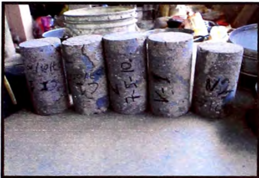
Figura 13 .- Aquí se tienen las muestras en reposo por 7 días para luego ser capeadas.
