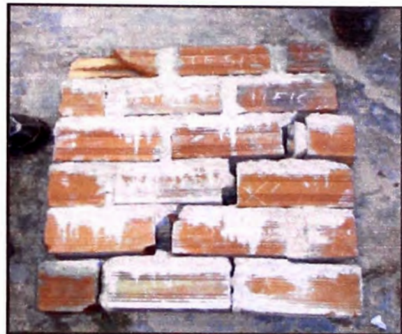
Figura 21. – Forma de corte del murete. (Fuente: Elaboración propia)
