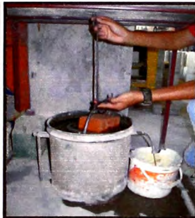
Figura 30.- Luego se coloca la muestra en una balanza hidrostática. (Fuente: Elaboración propia)
