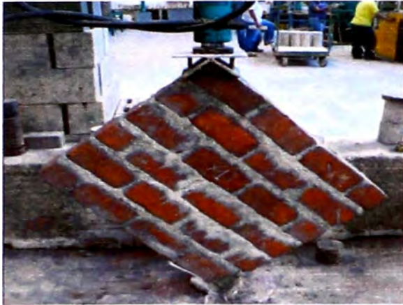
Figura 5.-Murete 1 para ser ensayado. (Fuente: Elaboración propia)
