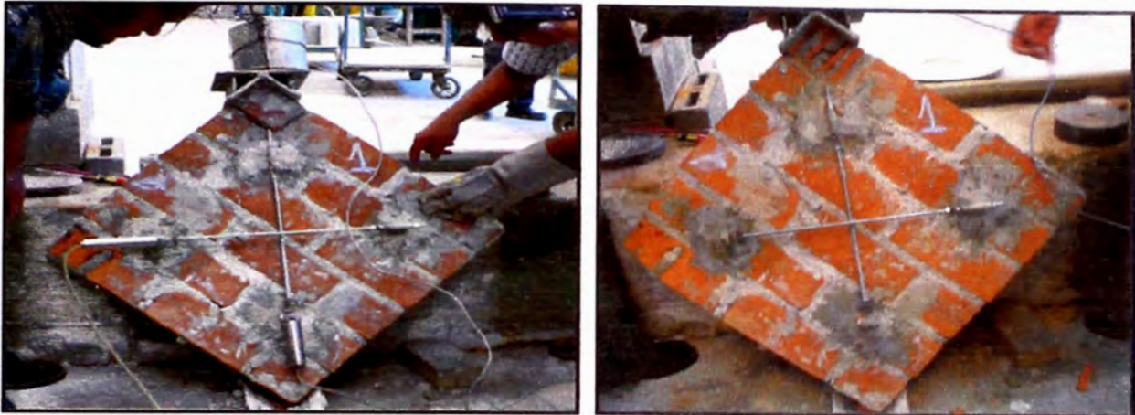
Figura 30. – Aquí se prepara el muerte para ser ensayado (Fuente: Elaboración propia)
