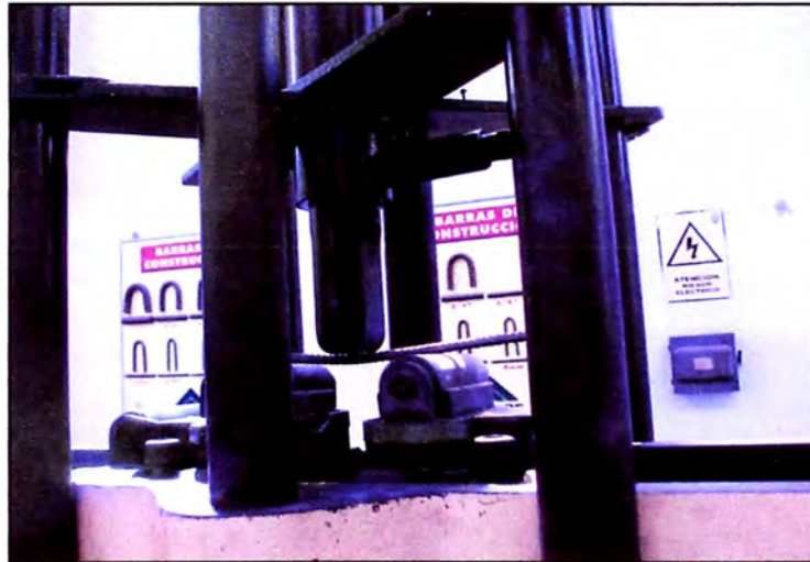
Figura 1.- Inicio del ensayo de doblado de acero (Fuente: Elaboración propia)
