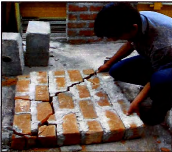
Figura 10.- Murete 2 siendo aplicada la carga vertical. (Fuente: Elaboración propia)
