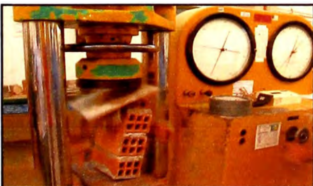
Figura 21.- Ensayo a compresión muestra 2 en el instante de rotura. Se observa la falla del ladrillo ubicado en la parte superior. (Fuente: Elaboración propia)
