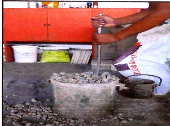
Figura 14. -Se golpea en forma de espiral, de adentro hacia fuera, y viceversa. (Fuente: Elaboración propia)
