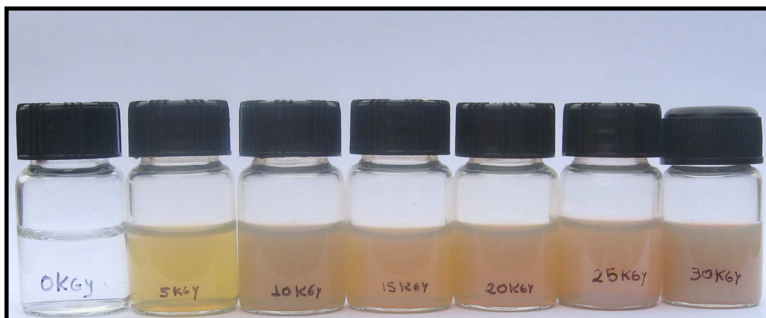
Figura 20. Fotografía de las soluciones coloidales de PVA/ plata fabricadas con diferentes Dosis de Radiación Gamma.
