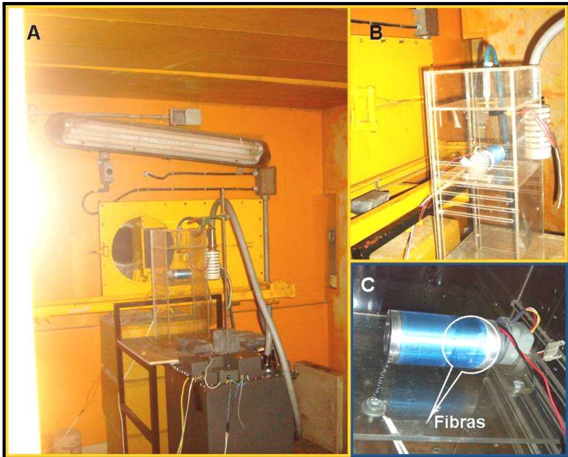
Figura 13. Fotografía del sistema Electrospinning para la irradiación con radiación gamma in situ de las nanofibras en el hall del reactor.
