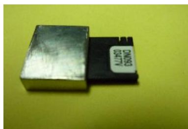
Figura C.3. Dosímetro nanodot con su build up de acero inoxidable de 2.0 mm de espesor equivalente a 15 mm de agua para un haz de fotones de 6 MV.
