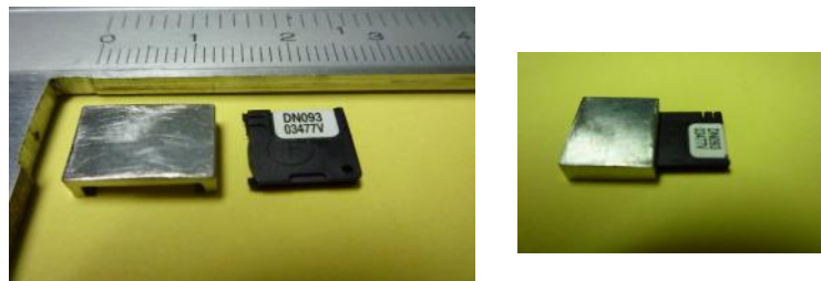
Figura 3.3. Dosímetro nanodot con el build up de acero inoxidable 316 de 2.0 mm de espesor, en la cual se muestran sus dimensiones (izquierda) y forma de uso (derecha).
