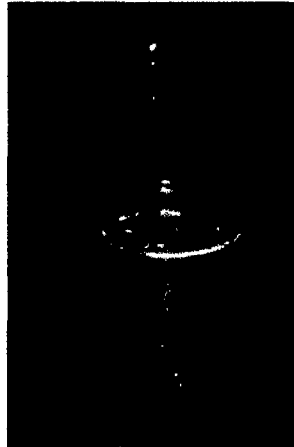
Figura 4.14: Potencial de ruptura de un dieléctrico
