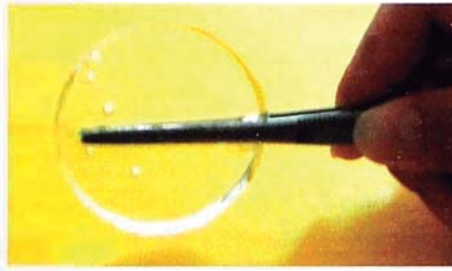
Figura 4.1. Hidrogel PVA-PVP entrecruzado radiolíticamente.
