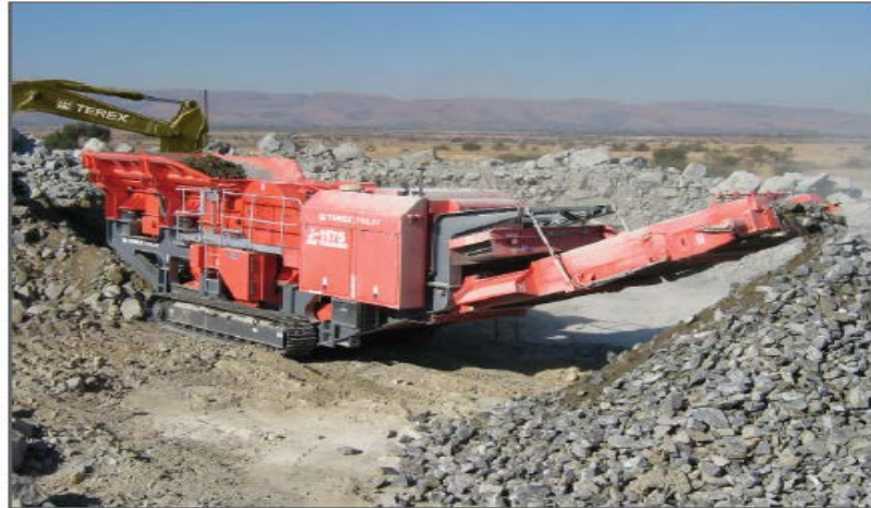
Fotografía 2.9: Trabajo combinado de retroexcavadora y chancadora móvil (Haomei Machinery Equipment Co. Ltd.)
