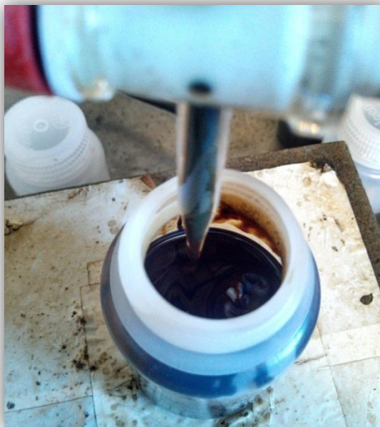
Figura 3.6. Preparación de mezcla. Agregado del segundo componente.
