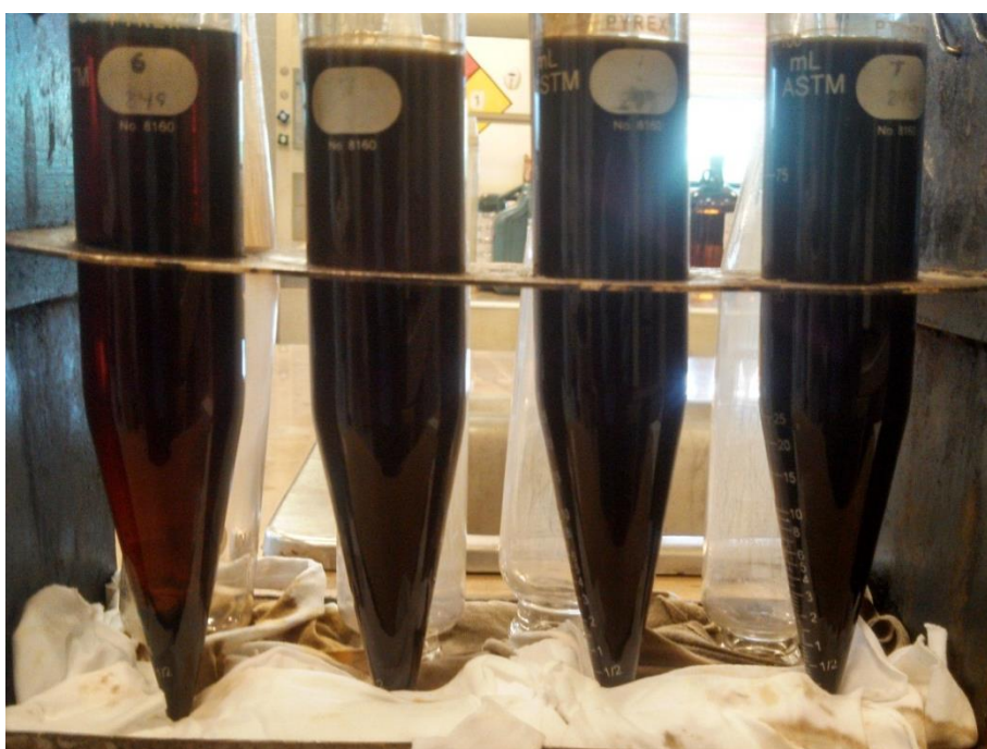
Figura 4.18. Evaluación cualitativa de reactivos inhibidores de precipitación de asfaltenos
