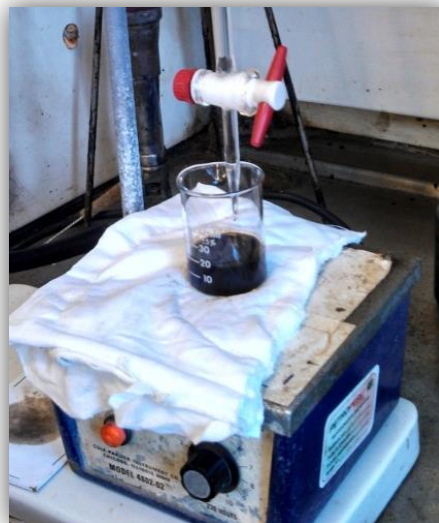
Figura 3.4. Titulación de solución muestra/tolueno con n-heptano
