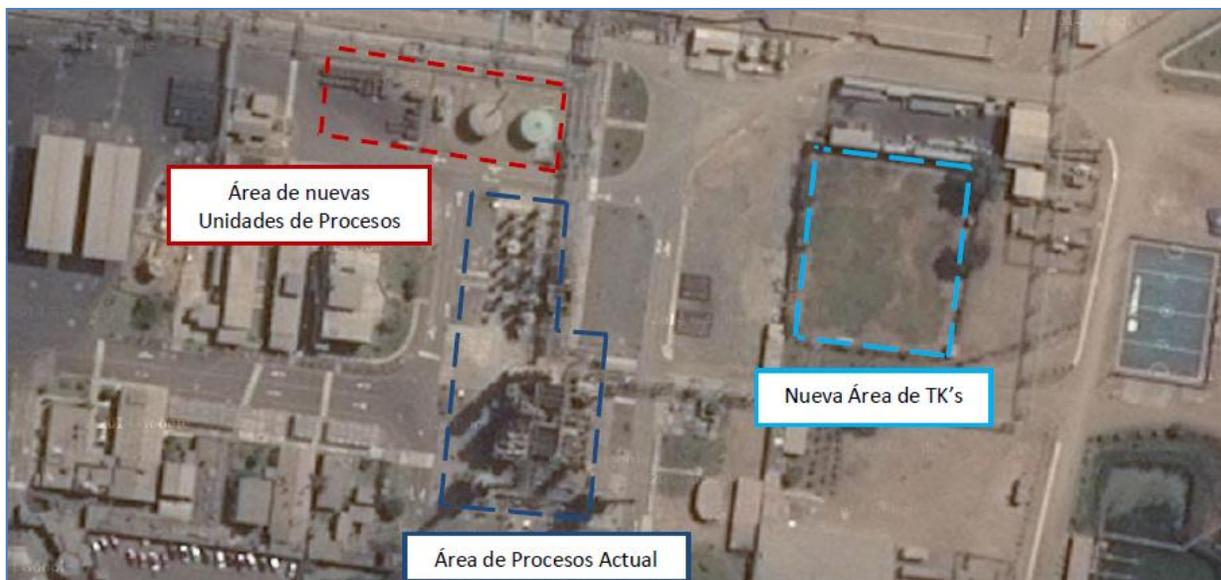
**Figura B-2: Áreas de Proceso actual, nueva y modificación de área de TK's.**
