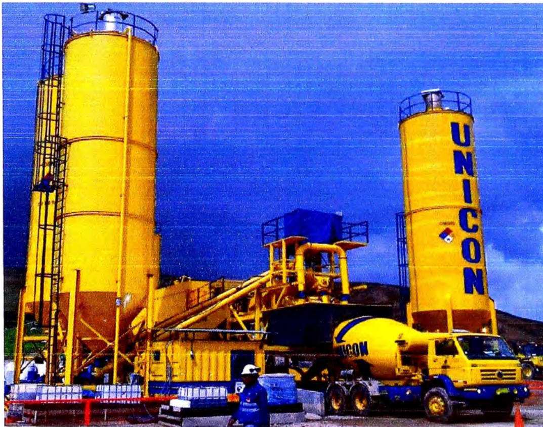
Foto 21. Planta de concreto premezclado para operaciones de UNICON.
