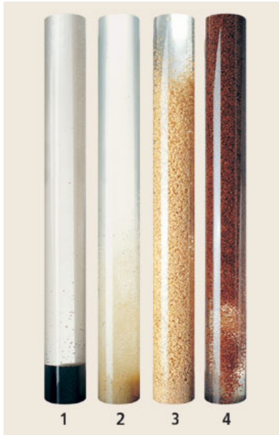
FIG. 2 Diferencias entre la velocidad de asentamiento de agentes de sostén convencionales respecto a los de baja densidad, (1=Bauxita, 2=Ottawa, 3 y 4= ULWP .
