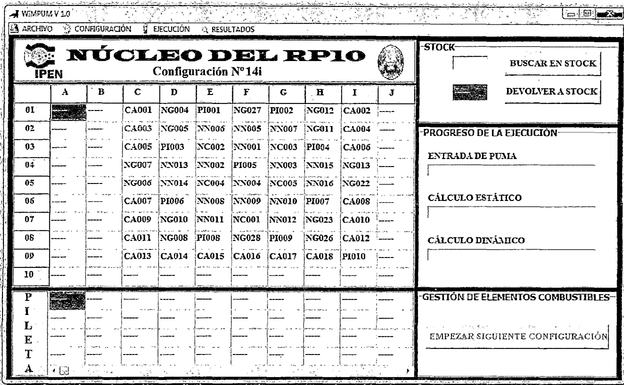
Figura 45. Imagen de la interfaz gráfica del programa WIMPUM con la configuración de núcleo N° 14A cargado.
