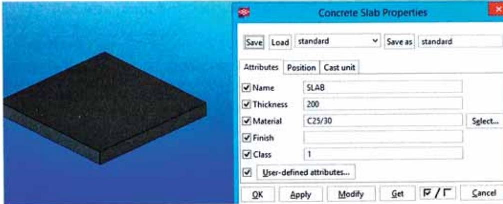
Figura N° 3.25 Atributos por defecto en Tekla Structures (Concrete Slab Properties)
