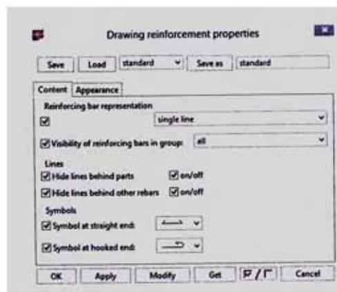
Figura N° 5.11 Propiedades de un objeto (acero de refuerzo) dentro de una vista y plano
