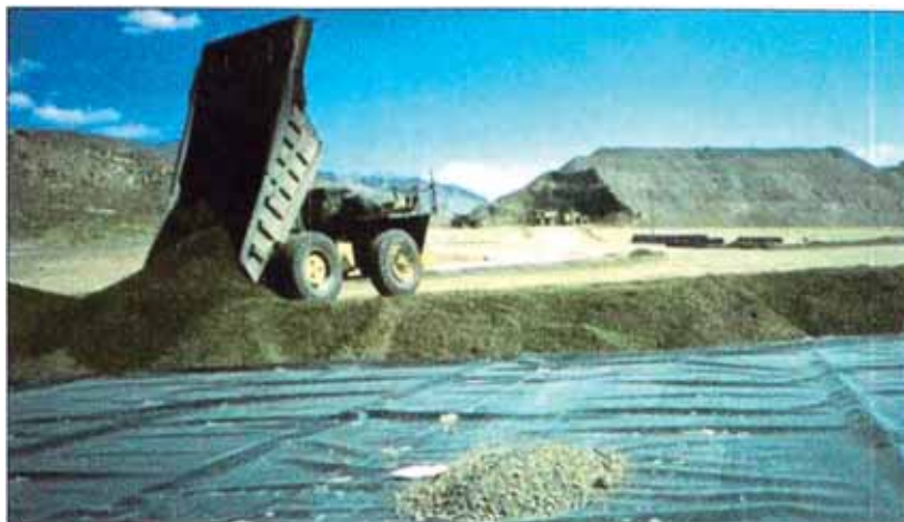
Figura N° 2.3: Conformación de la pila de lixiviación
