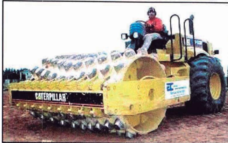
Figura N° 4.3.- rodillo “pata de cabra” para compactación de suelo fino.
