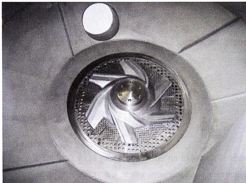
Figura 3.4 Rotor de hidrapulper de baja consistencia.
