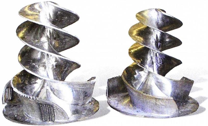
Figura 3.5 Rotor de hidrapulper de alta consistencia.
