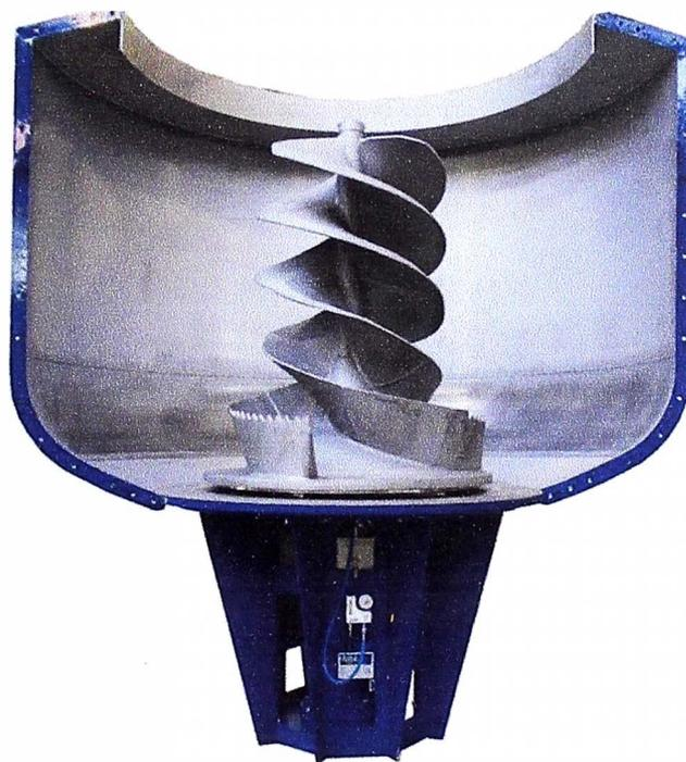
Figura 3.7 Vista en corte de un hidrapulper de alta consistencia.
