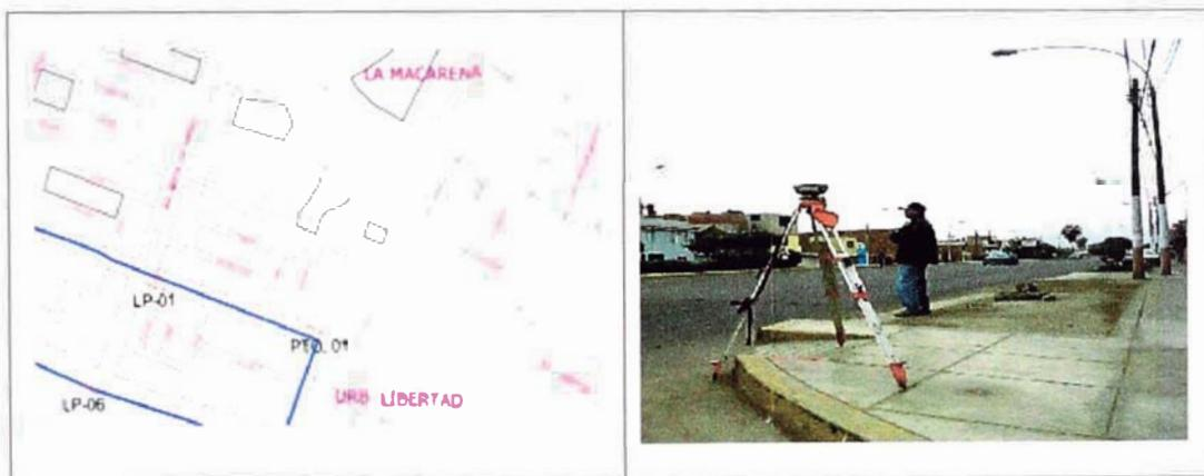
Figura N°5: Ubicación del punto geodésico LP 1 de la poligonal de apoyo
