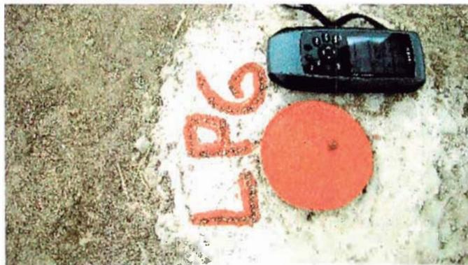
Fotografía N°22: Punto geodésico LP 6 de la poligonal de apoyo
