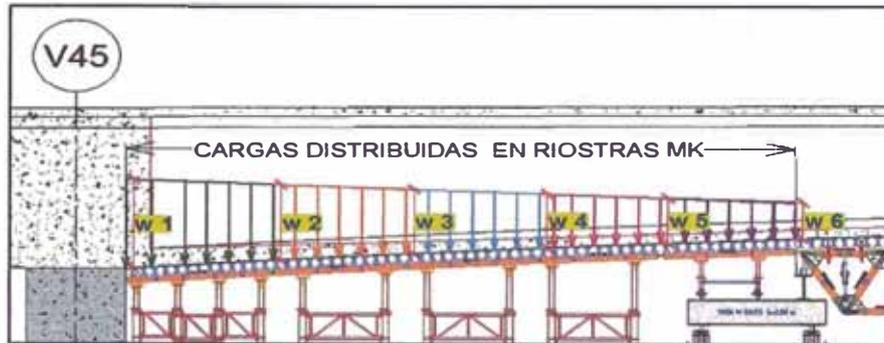
Figura N°3.20.- Esquema de cargas (ton/m) sobre riostras MK – Eje V45.
