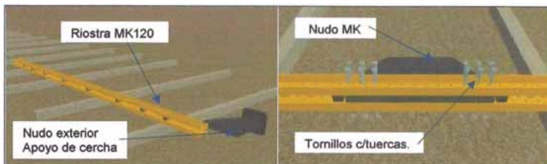
Figura N°3.51.- Colocación de riostras MK y nudos MK.
