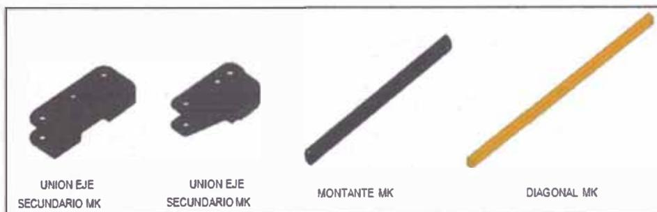
**Figura N°2.15.- Principales elementos de arriostamiento.**
