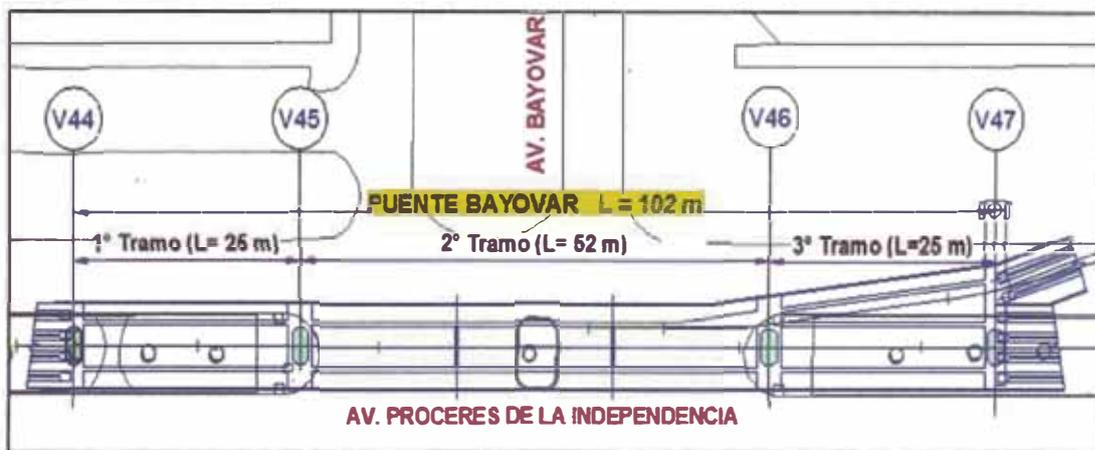
Figura N°3.5.-Esquema de proyección del Puente Bayovar.
