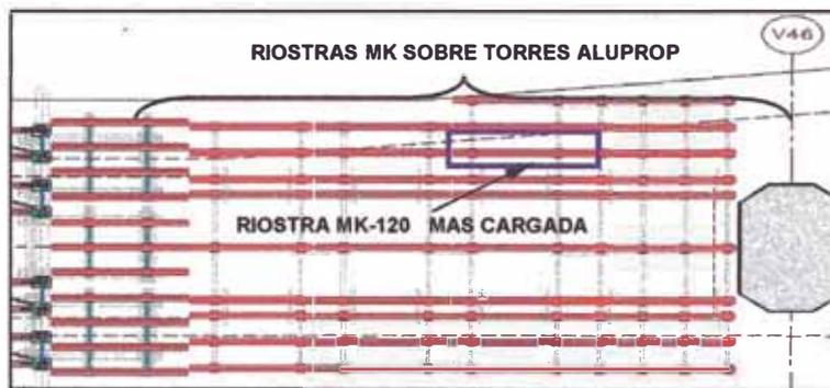
Figura N°3.28.- Esquema de riostra MK-120 más cargada.
