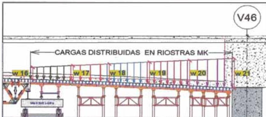
Figura N°3.21.- Esquema de cargas (ton/m) sobre riostras MK – Eje V46.
