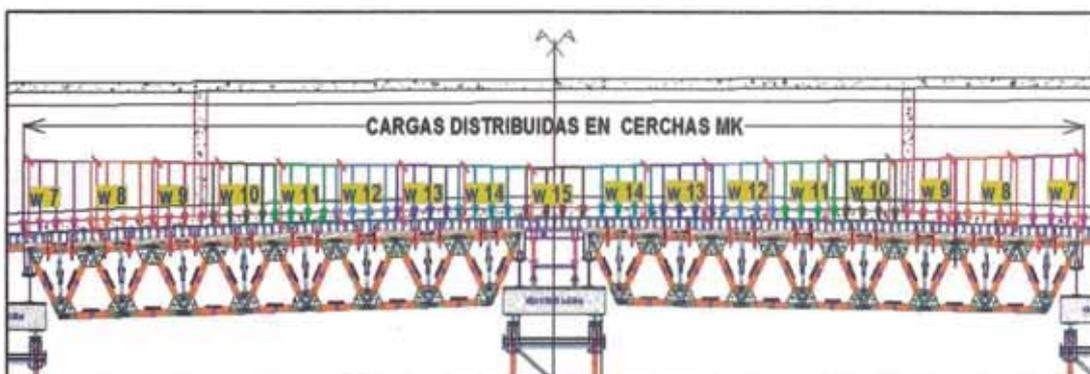
Figura N°3.22.- Esquema de cargas (ton/m) sobre Brida superior de cerchas– Tramo Central
