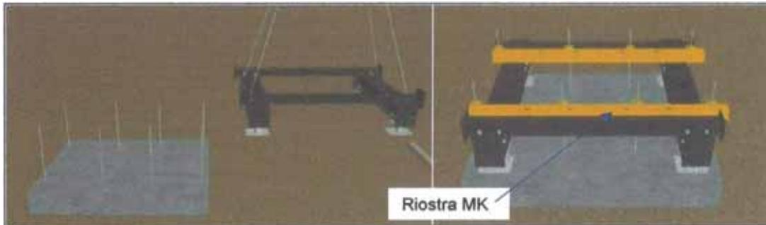
Figura N°3.56.- Montaje de la base de la cimbra MK.
