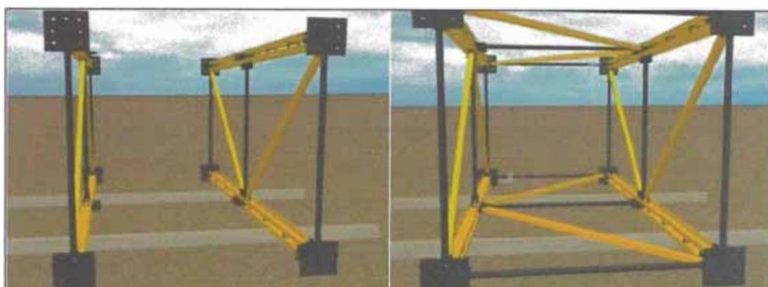
Figura N°3.58.- Colocación de arriostamiento lateral.
