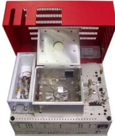
*Fig. 2.3. Cromatógrafo Con Detector de Ionización de Flama*
