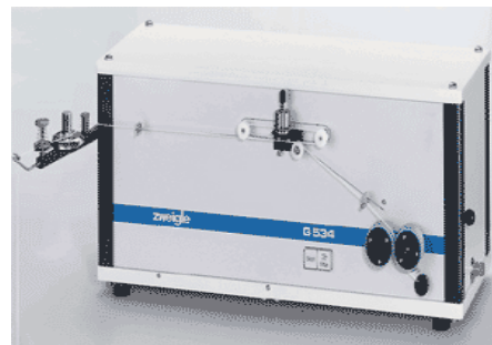
Figura 23: Dispositivo para medir el coeficiente de fricción: u-meter
