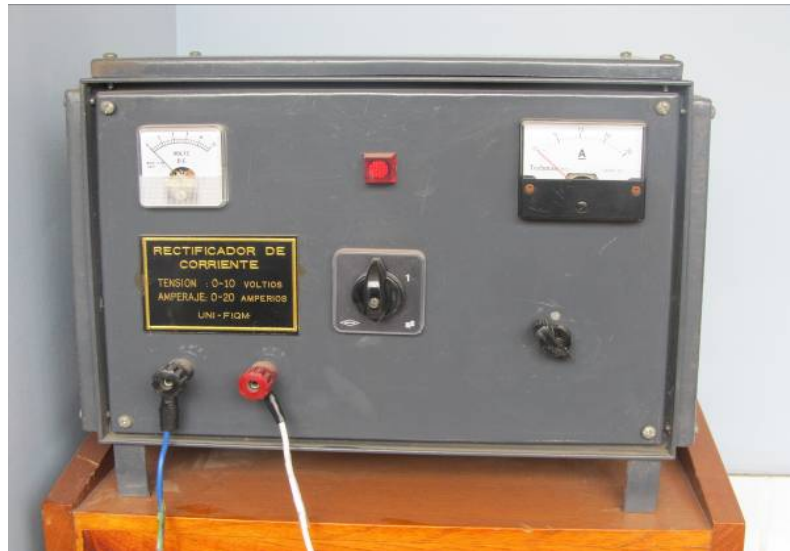
Figura 6: Rectificador utilizado para el electropulido del acero.
