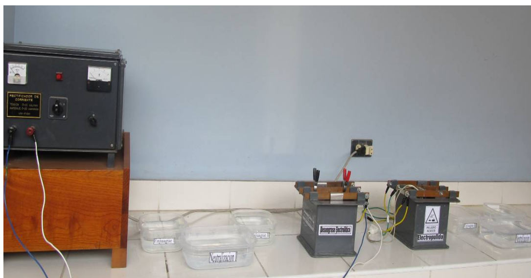
Figura 12: Esquema de trabajo del pulido electrolytico del Acero.
