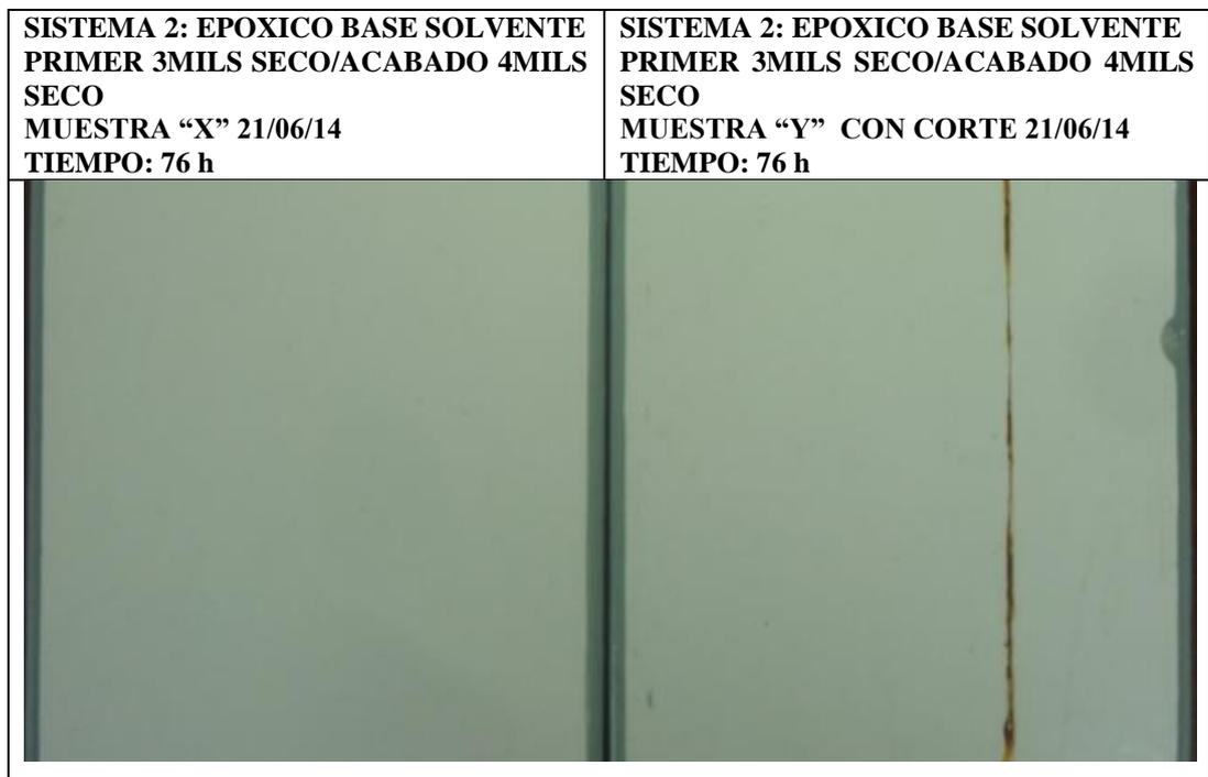
**Figura 18. Pruebas en Cámara de Niebla Salina: 76 horas de exposición**
