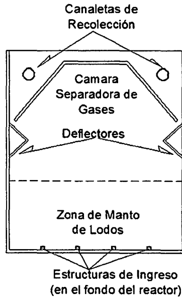
Figura III.27: Sección transversal típica del reactor piloto UASB.
