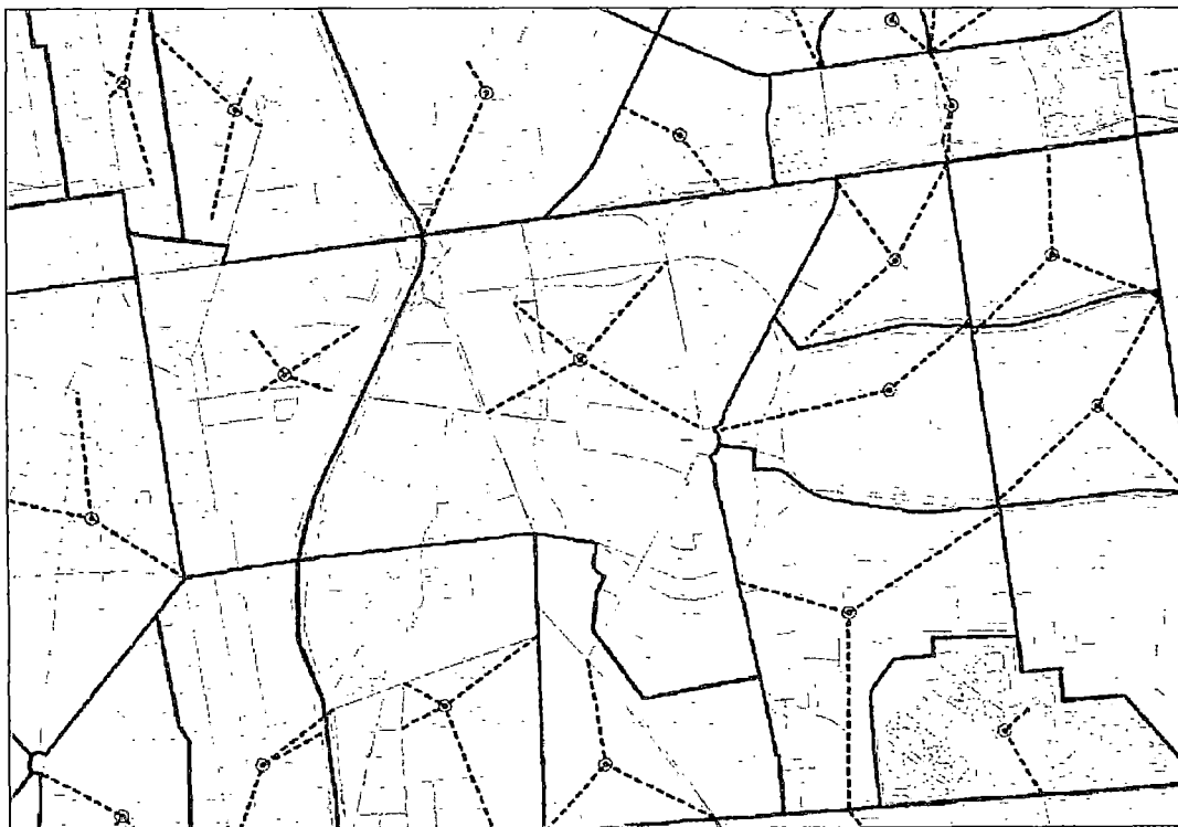
Figura N° 72: Detalle conectores y centroides
